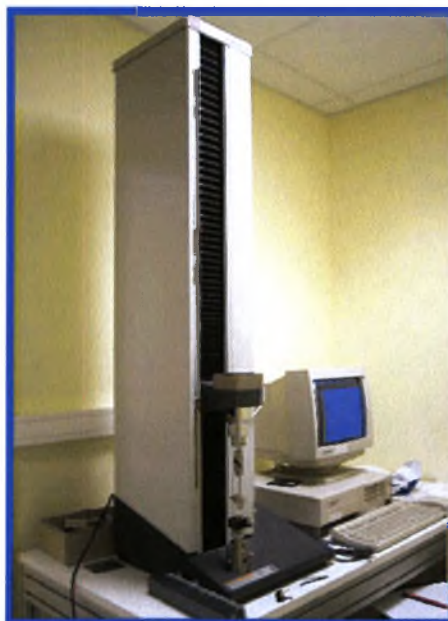
Εικ. 33 Δοκός Εικ. 34 Δοκός μηχανής εφελκυσμού εφελκυσμού ενός κ ενός κοχλία (φωτο 20 [6])
