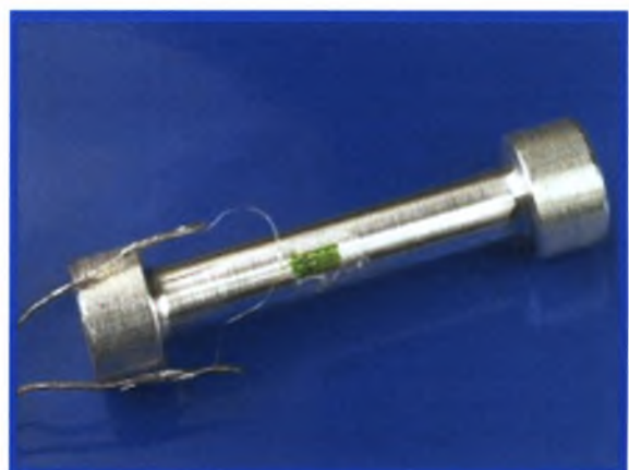
Εικ. 39 Επιμηκυνσιόμετρο τοποθετημένο στο δοκίμιο
