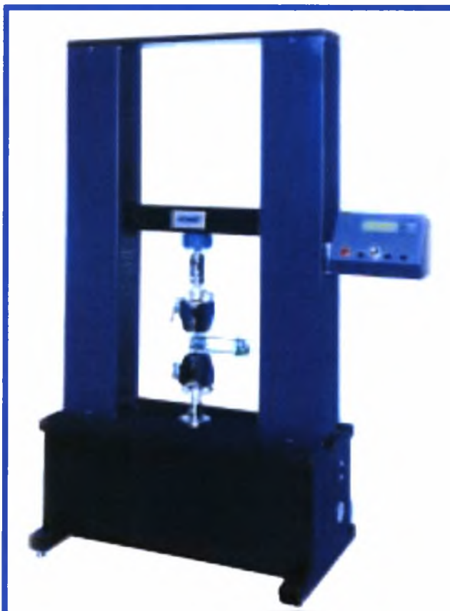
Εικ. 23 Ηλεκτρομηχανικού τύπου μηχανή εφελκυσμού [12]
