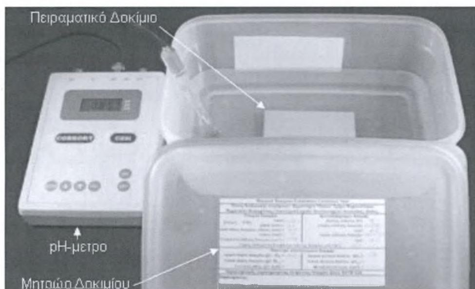
Σχήμα 4.11: Πειραματική διάταξη δοκιμής EXCO.
