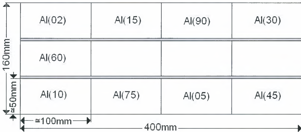
Σχήμα 4.2: Επιλογή δοκιμίων από το plate FCG2-a.
