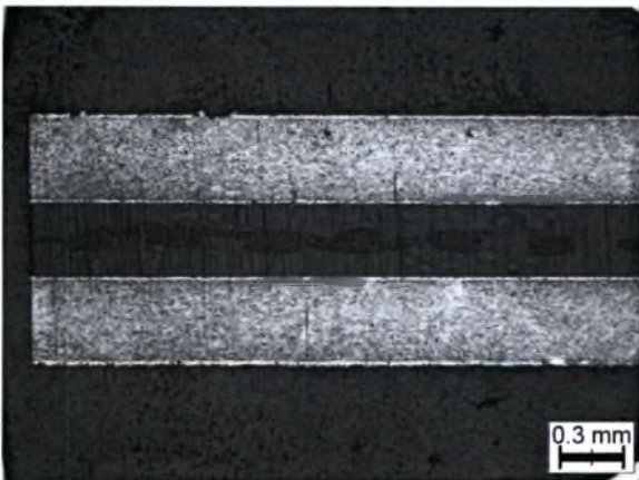
Σχήμα Δ.5: Δοκίμιο Al(O 2 ), οπτική μικροσκοπία. (α) και (β) διαμήκης τομή, (γ) και (δ) εγκάρσια τομή.
