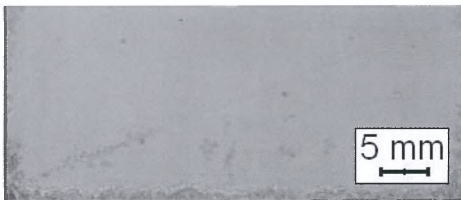
Σχήμα 6.11: Προσβολή στις ακμές και τα ελαττώματα της επιφάνειας των δοκιμίων.
