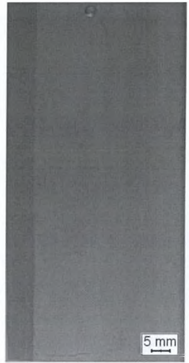
Σχήμα Δ1: Φωτογραφίες των δοκιμίων Al πριν τη διεξαγωγή της πειραματικής δοκιμής επιταχυνόμενης διάβρωσης, επιφάνεια I. (α) Al(02), (β) Al(05), (γ) Al(10), (δ) Al(15), (ε) Al(30), (στ) Al(45), (ζ) Al(60), (η) Al(75), (θ) Al(90).
