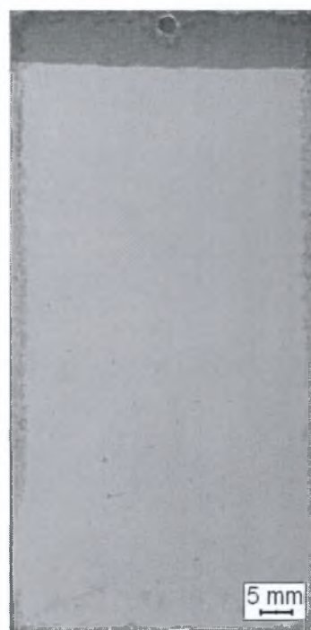
Σχήμα 6.19: Δοκίμιο Al(45) όπως ήταν αναρτημένο στο διαβρωτικό διάλυμα.
