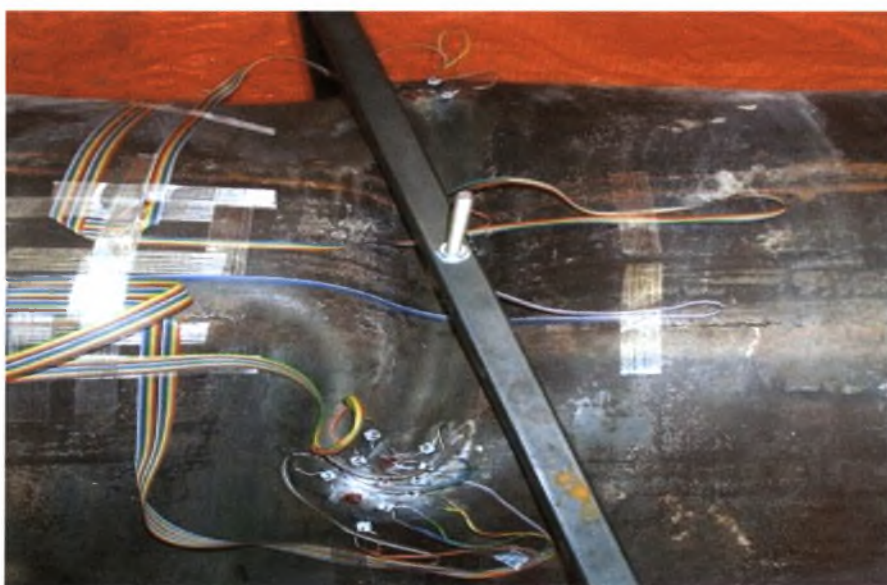
Σχήμα 2.7 Σημεία τοποθέτησης των μηχανομετρών, στο 3° πείραμα .
