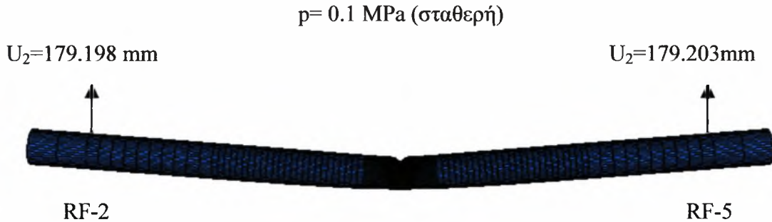
Σχήμα 4.6 Φόρτιση στο 7 ο βήμα.
