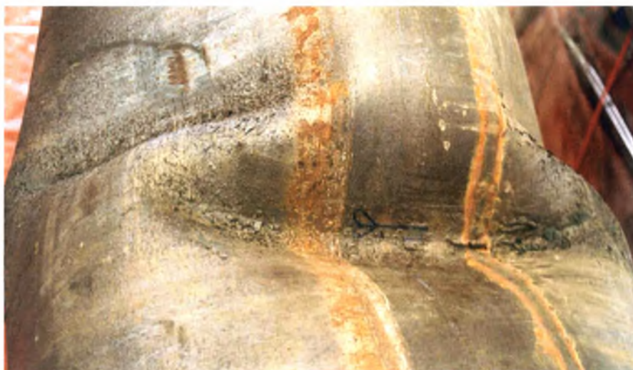
Σχήμα 2.6 Μορφή του τοπικού λυγισμού στο 3° πείραμα.
