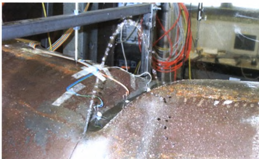
Σχήμα 2.8 Διαρροή του αγωγού, μετά από 98 κύκλους φόρτισης με \Delta u=75\text{mm} , στο 1 ο πείραμα..
