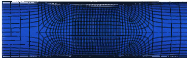
Σχήμα 3.4 Δόμηση πλέγματος γύρω από τη μεσαία διατομή, στο κάτω μέρος του αγωγού.
