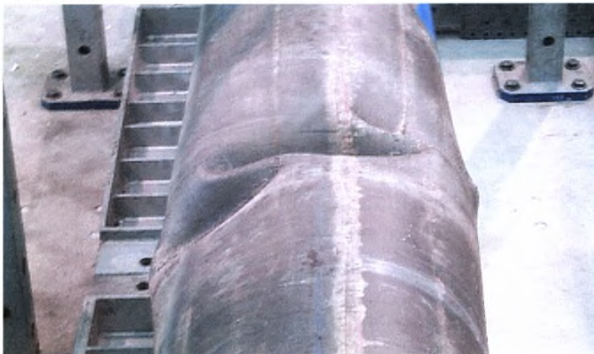
Σχήμα 2.4 Μορφή του τοπικού λυγισμού στα πειράματα 1 & 2.
