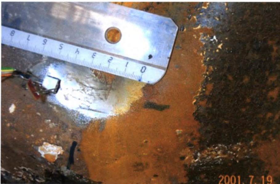
Σχήμα 2.9 Διεύθυνση και τοποθεσία ρωγμής, στο 2° πείραμα.
