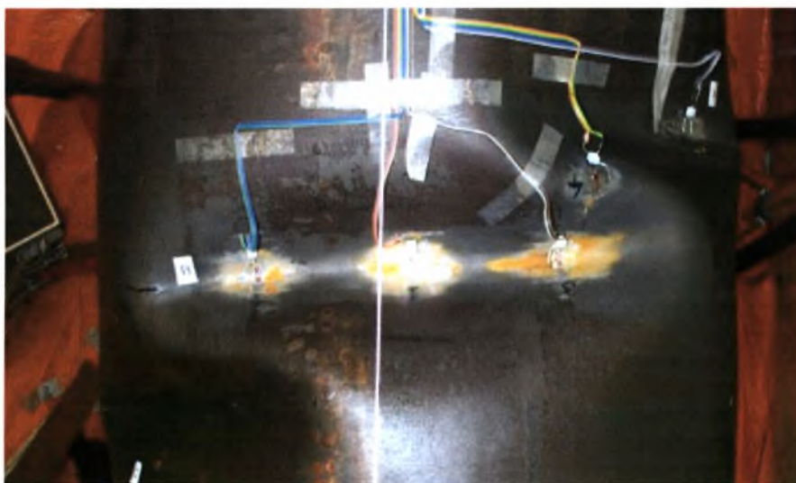
Σχήμα 2.5 Σημεία τοποθέτησης των μηχανοσιόμετρων, στα πειράματα 1 & 2.
