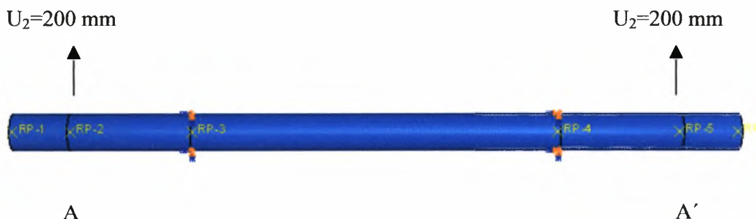
Σχήμα 3.14 Φόρτιση στο 4 ο βήμα.
