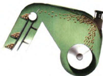
Σχήμα 5: Αισθητήρας μέτρησης παραγωγής.
