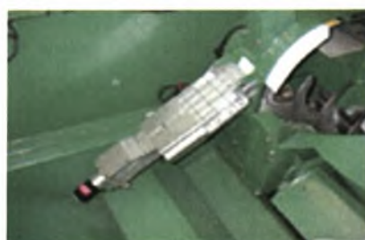
Σχήμα 6: Αισθητήρας μέτρησης υγρασίας.
