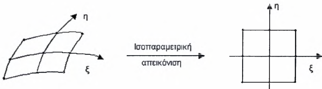
Σχήμα 4.3. Σχηματική αναπαράσταση της μετατροπής μιας στρεβλής γεωμετρίας σε κανονική με τη μέθοδο της ισοπαραμετρικής απεικόνισης
