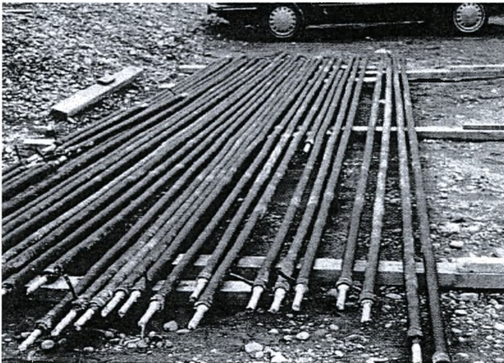
Εικ. 1. 4 : Ήλοι επικαλυμμένοι με HDPE για την περαιτέρω αντιδιαβρωτική τους προστασία (Porterfield et al., 1994).
