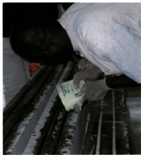
Σχήμα 3.11 Μορφοποίηση των εσωτερικών επιφανειών με χρήση ρητίνης
