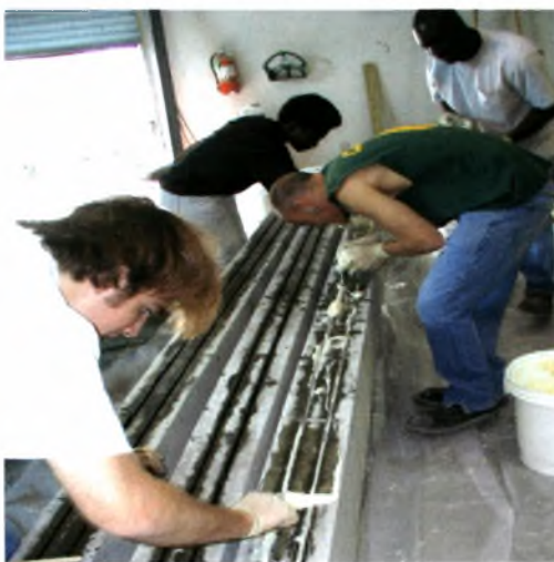
Σχήμα 3.11 Μορφοποίηση των εσωτερικών επιφανειών με χρήση ρητίνης
