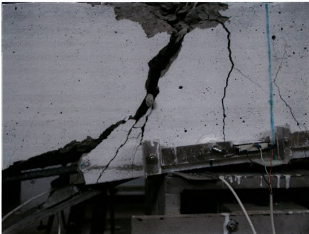
Σχήμα 3.29 Λεπτομέρεια αστοχίας . Η πράσινη γραμμή δείχνει το μέσο του ανοίγματος
