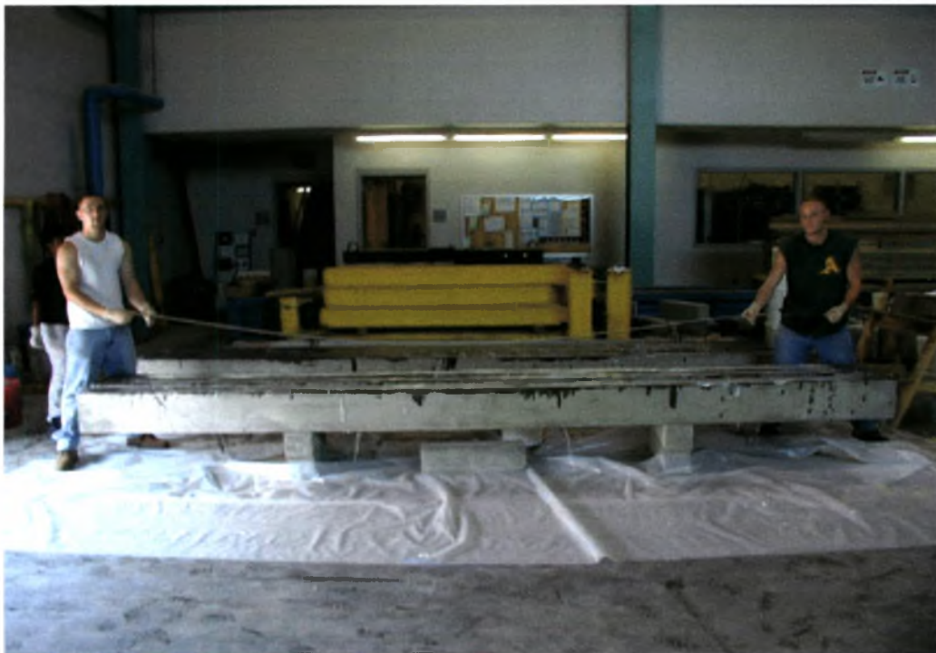
Σχήμα 3.7 Επικόλληση του ελάσματος
