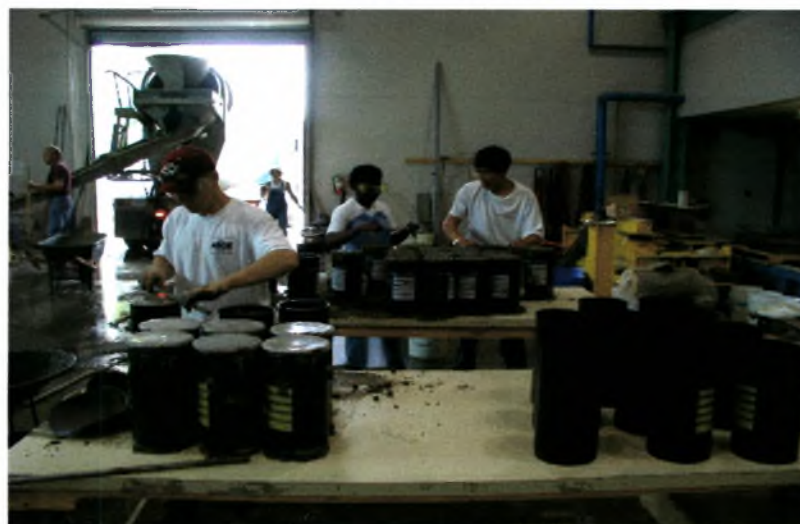
Σχήμα 3.3 Κατασκευή Κυλινδρικών δοκιμίων
