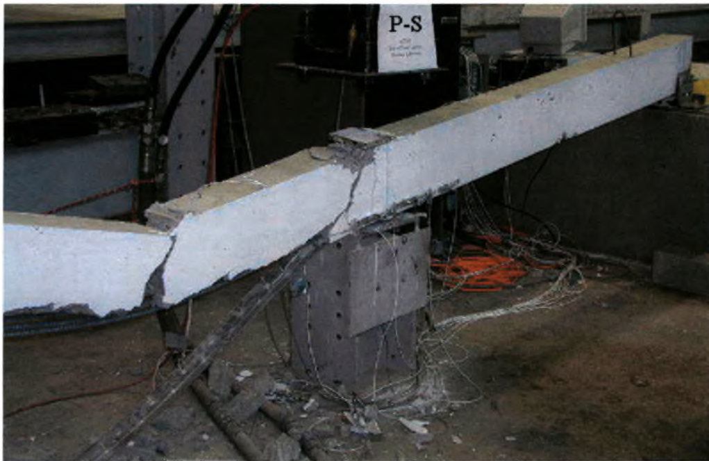
Σχήμα 3.28 Τελική μορφή δοκού P -S μετά την αστοχία
