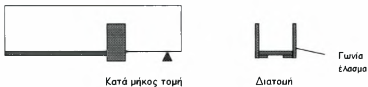
(a) Πλευρική ενίσχυση με γωνία-έλασμα από ίνες γυαλιού
