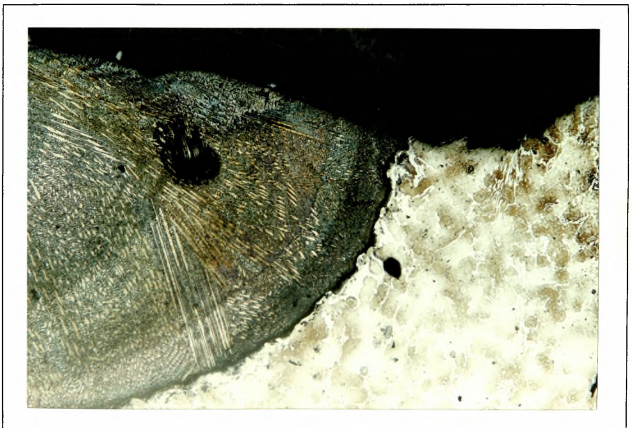
Φώτο. 23: (X100). Αναγόμωση με Soudofonte B 24 (1δ).
