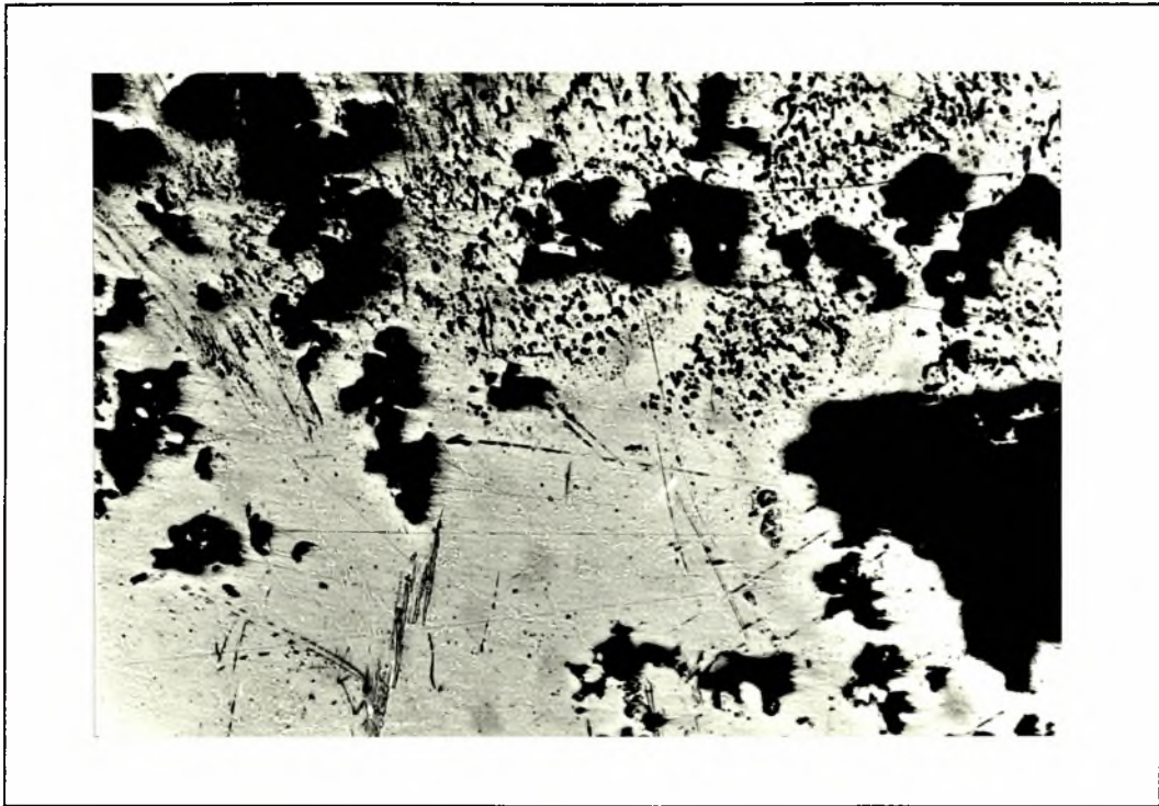
Φώτο. 9: ( X50). Διάβρωση σε βάθος του χάλυβα Fonte á Cr.
