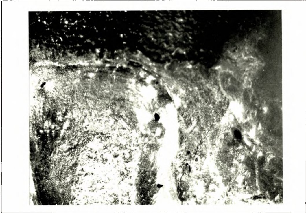
Φώτο. 20: (X6,5). Αναγόμευση με Soudofonte B 24 (1δ). Πόροι και ρωγή εφαπτομενικά.
