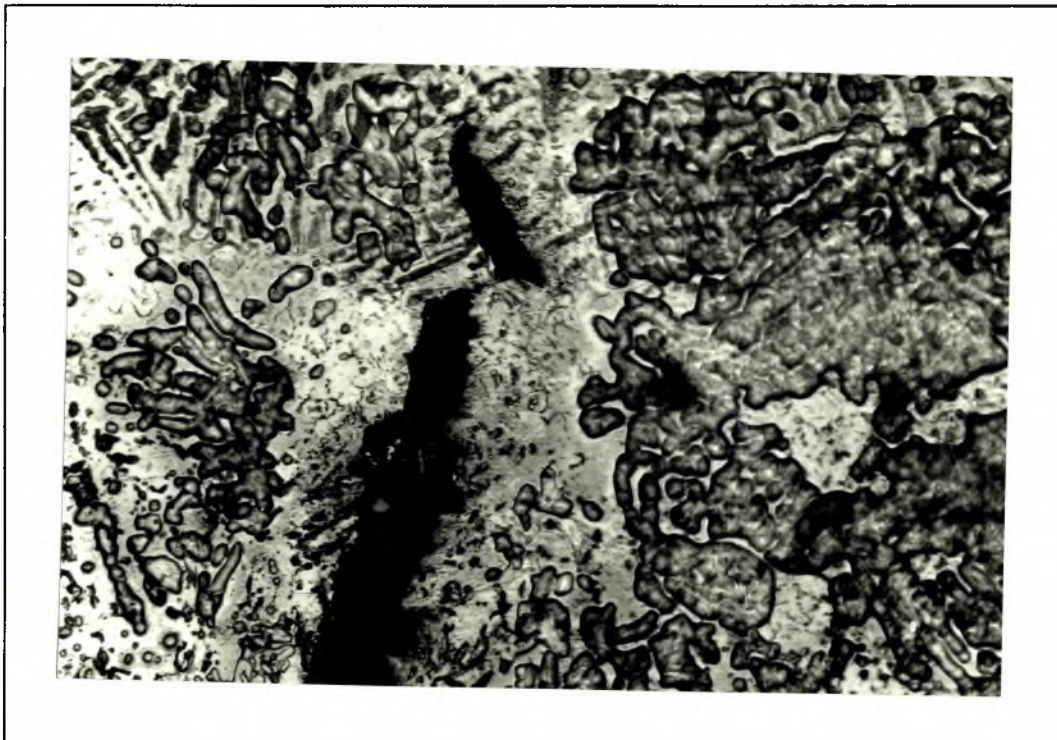
Φώτο. 44: (X200). Αναγόμευση με Soudocrom S 17 (2). Το ρήγμα της φωτ.43 διακόπτεται στην περιοχή του ηλεκτροδίου.
