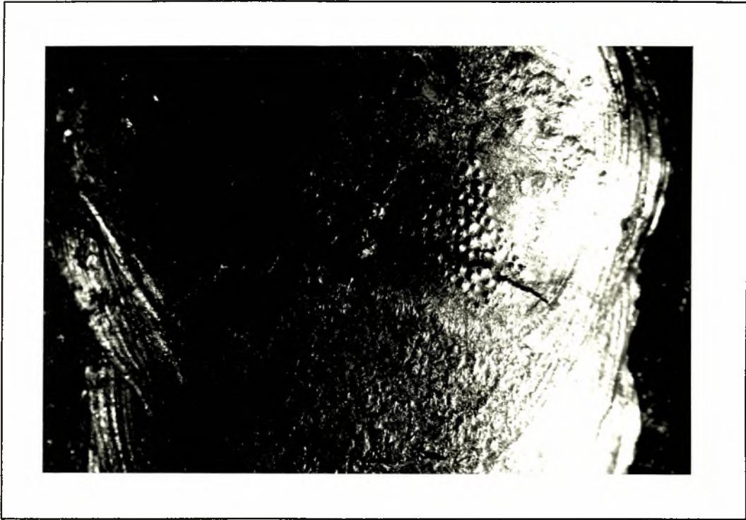
Φώτο. 33: (X6,5). Αναγόμωση με Soudocrom S 17 (2). Ρωγμή στο τέλος της ραφής.
