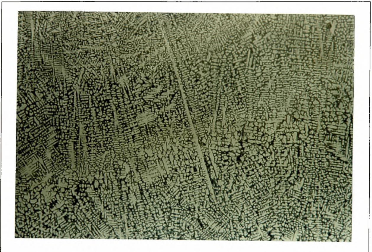
Φώτο. 22: (X100). Αναγόμωση με Soudofonte B 24 (1δ). Δενδριτική δομή ηλεκτροδίου.
