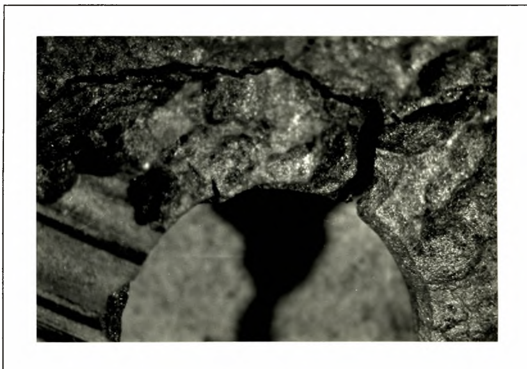
Φώτο. 4: (X6,5). Διάβρωση σε βάθος του χάλυβα Fonte á Cr.
