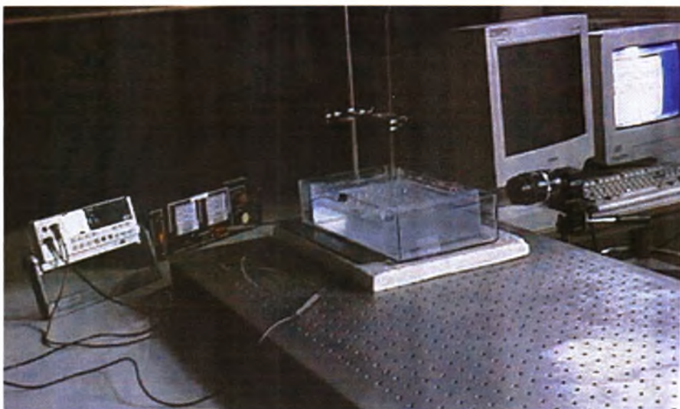
Σχήμα 5.3 Μοντέλο λεκάνης, κάμερα CID, τροφοδοτικό τάσης, πολύμετρο
