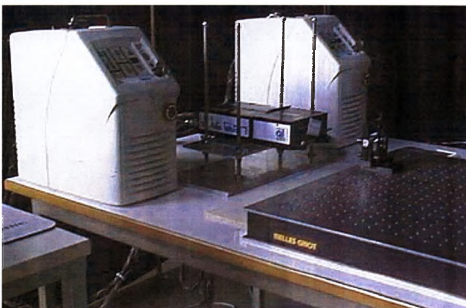
Σχήμα 5.4 Σύστημα Laser Nd: YAG, κεφαλή εξόδου της δέσμης, κυλινδρικός φακός
