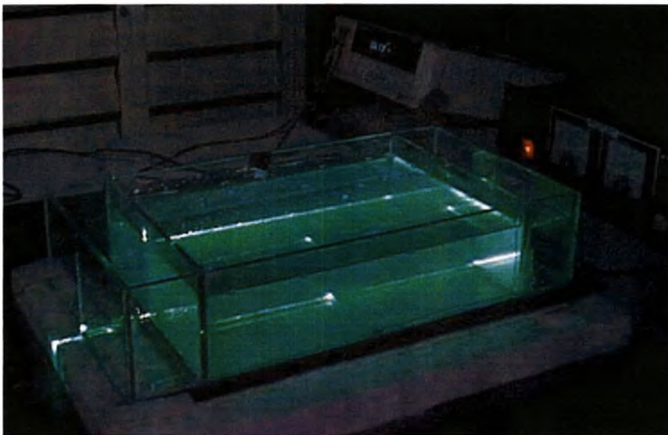
Σχήμα 5.5 Φυσικό μοντέλο λεκάνης τήξης φωτιζόμενο από το φως της δέσμης Laser
