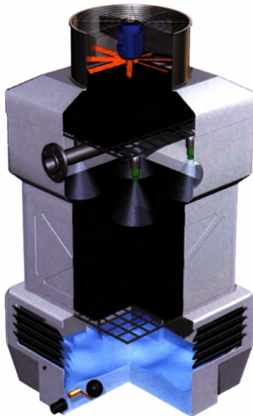
Εικόνα 12: Σχεδιάγραμμα ανοικτού τύπου πύργου ψύξης – διακρίνεται το μαύρου χρώματος πληρωτικό υλικό στο μέσο του πύργου[10]
