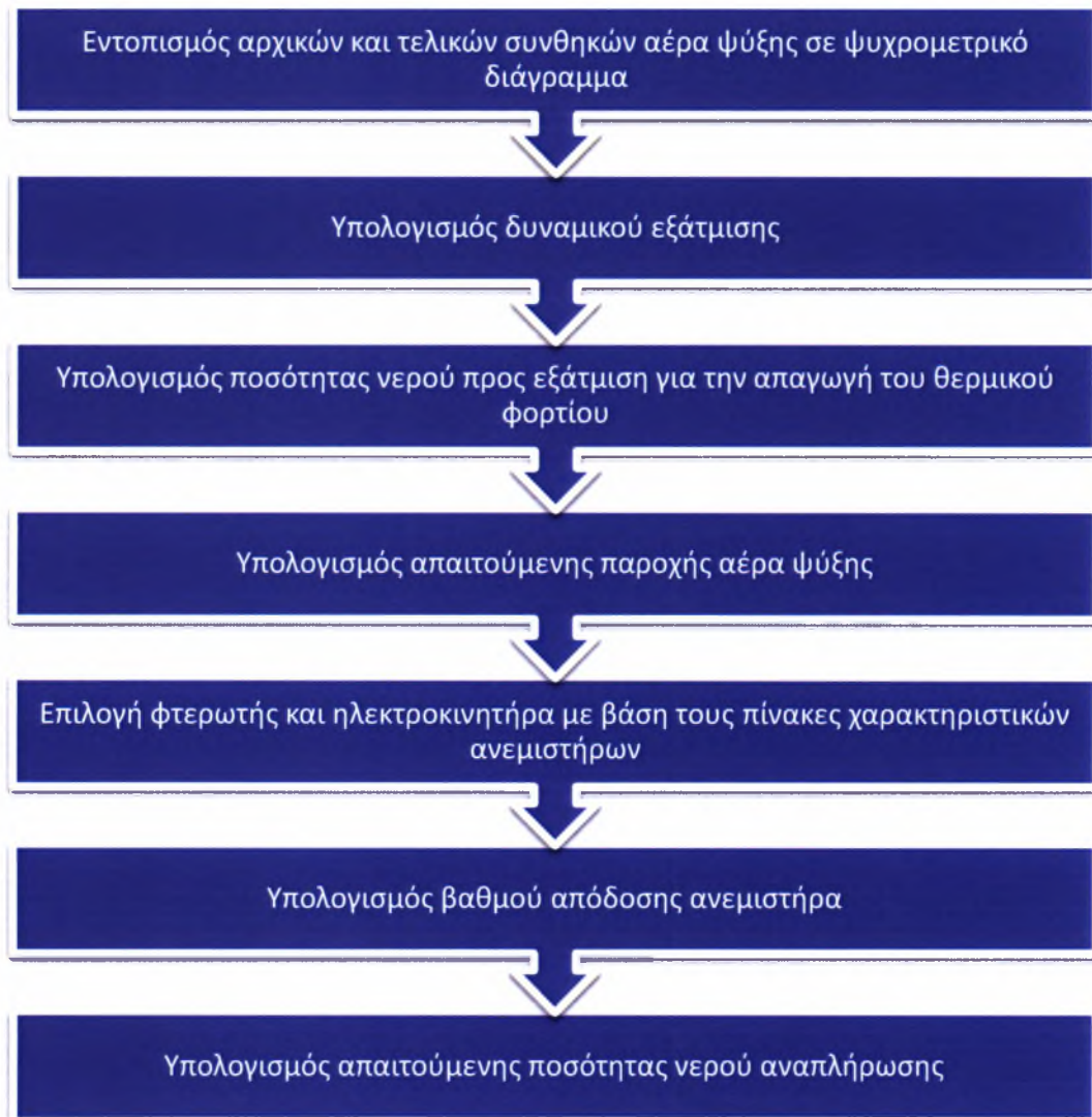
Διάγραμμα 14: Λογικό διάγραμμα απεικόνισης σταδίων υπολογισμού χαρακτηριστικών λειτουργίας πύργων ψύξης
