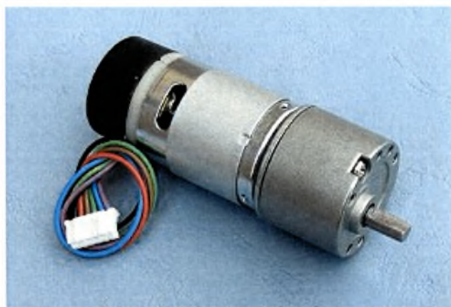
Εικόνα 4.23 – EMG30 κινητήρας όπου φαίνεται χαρακτηριστικά και η φίσα σύνδεσης με το MD25.
