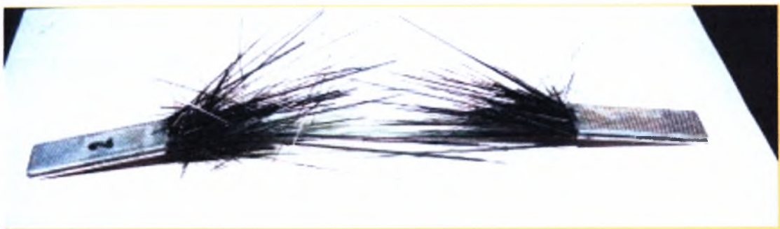
Σχήμα 1.5.3: Αστοχία δείγματος ΙΟΠ.
