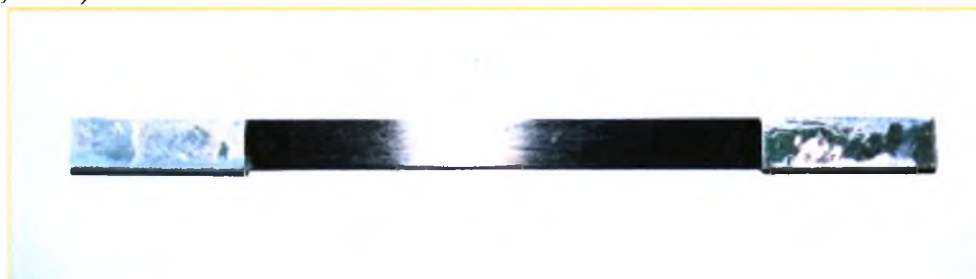
Σχήμα 1.5.1: Δείγμα ΙΟΠ για τον προσδιορισμό της εφελκυστικής αντοχής του
