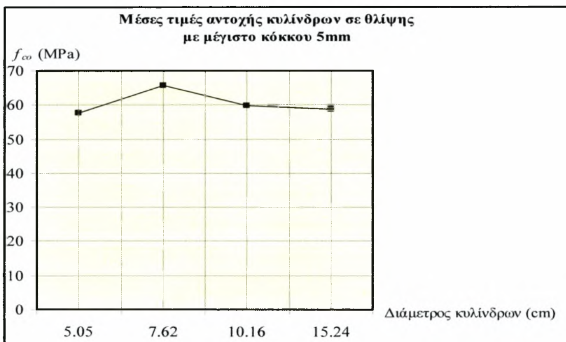
Σχήμα 6.2.3: Σχηματική αναπαράσταση αντοχής κυλίνδρων β' κοκκομετρικής διαβάθμισης δοκιμίων [21]
