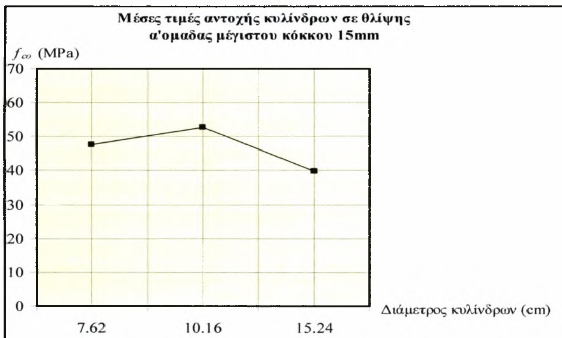
Σχήμα 6.2.1: Σχηματική αναπαράσταση αντοχής κυλίνδρων α' ομάδας α' κοκκομετρικής διαβάθμισης [21]
