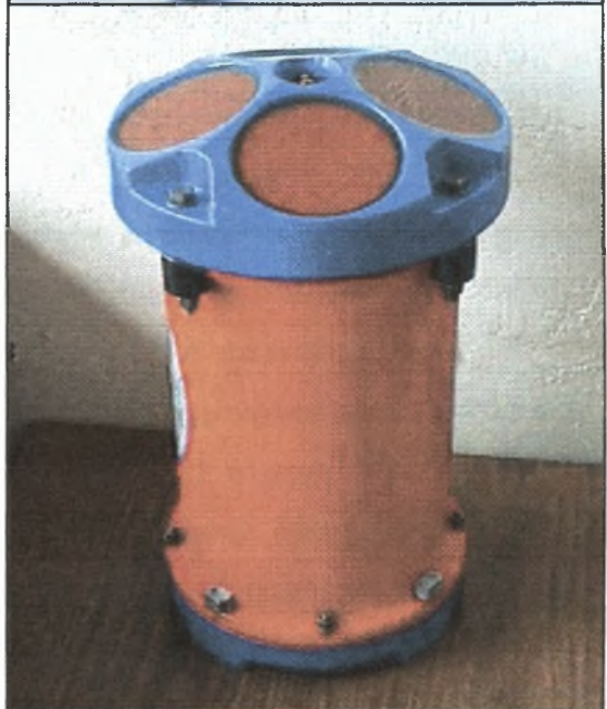
Εικόνα 1.15 ADCP: Μεγάλων βαθών (πάνω) και μικρών βαθών (κάτω)
