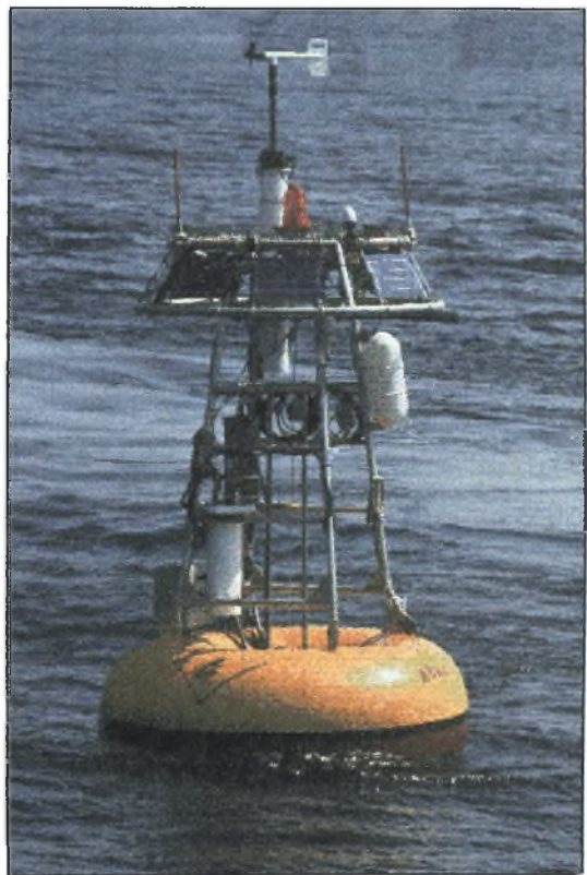
Εικόνα 1.2 Αγκυροβόλιο με μετεωρολογικό εξοπλισμό
