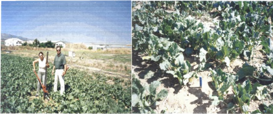
Εικόνα 5.10 Τοποθέτηση αισθητήρων μέτρησης εδαφικής υγρασίας (α) και η κεφαλή του αισθητήρα όπως φαίνεται στον αγρό (β).
