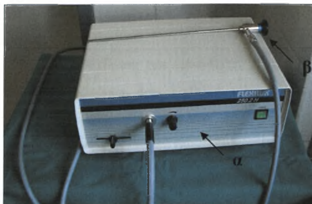
α: Φωτεινή πηγή ψυχρού φωτισμού β: Ενδοσκόπιο
