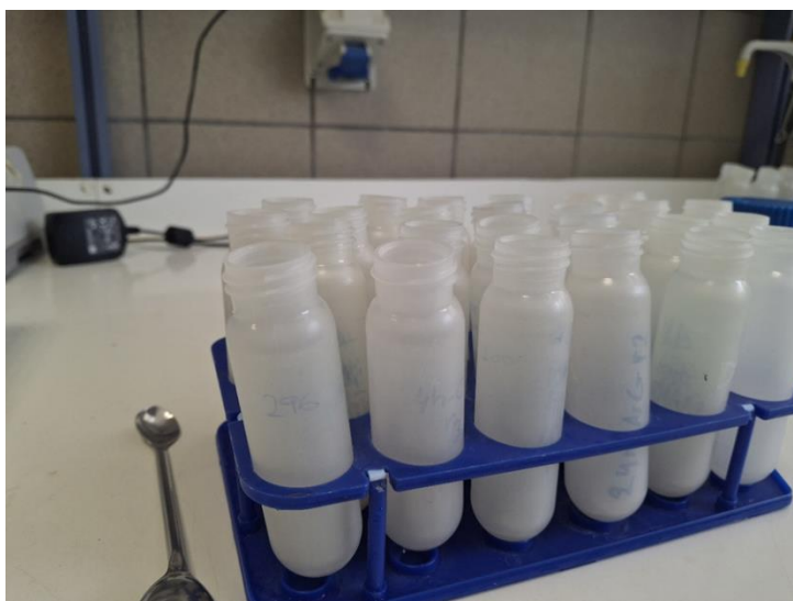
Εικόνα 6: Χρήση συγκεκριμένων πλαστικών σκευών (σωληνάρια Teflon) για το βήμα της φυγοκέντρωσης των δειγμάτων εδάφους έπειτα από την 4ωρη επώαση
