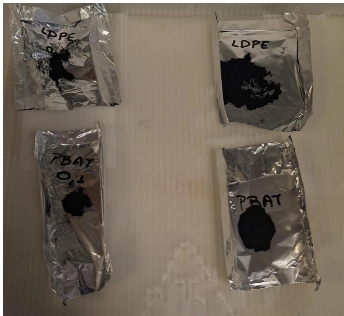
Εικόνα 5 : Διαφορετικοί τύποι μικροπλαστικών (LDPE/PBAT) και συγκεντρώσεων (0,1 και 1 w/w) που χρησιμοποιήθηκαν στην παρούσα μελέτη.
