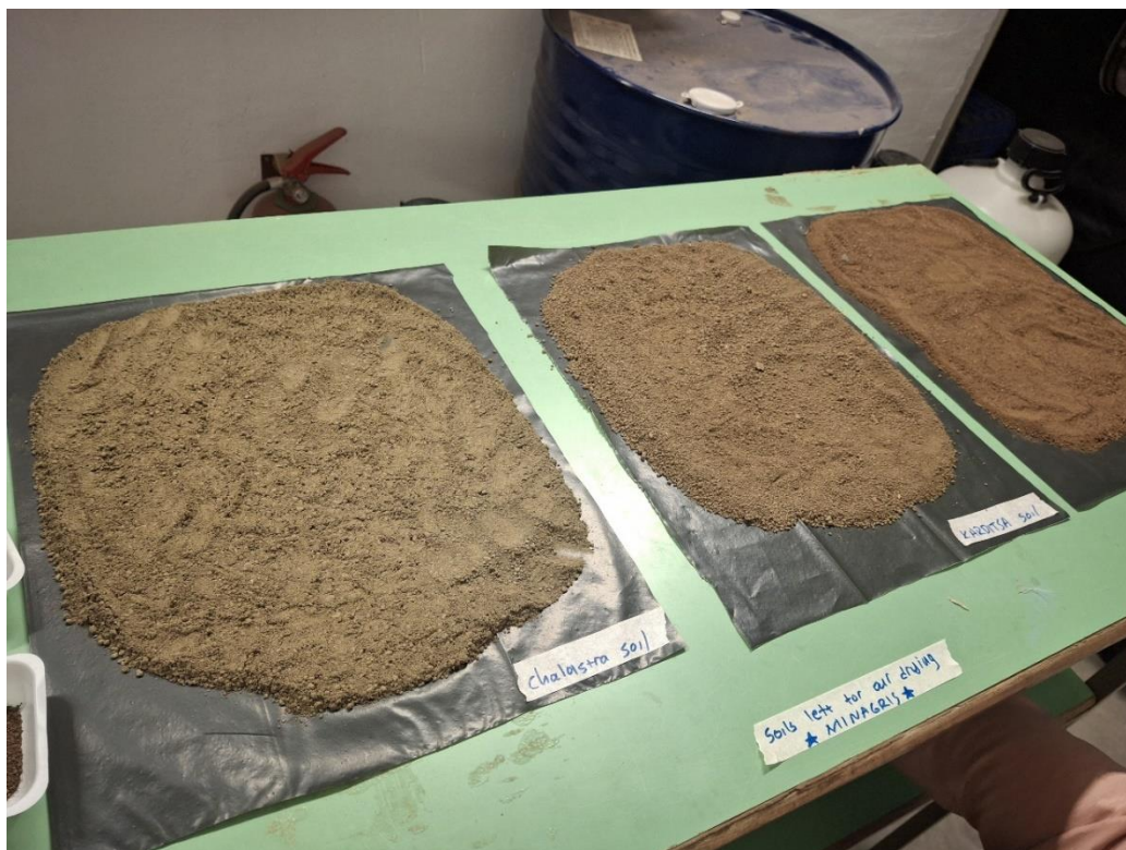
Εικόνα 4: Διαδικασία φυσικής ξήρανσης με αέρα των εδαφών που χρησιμοποιήθηκαν
