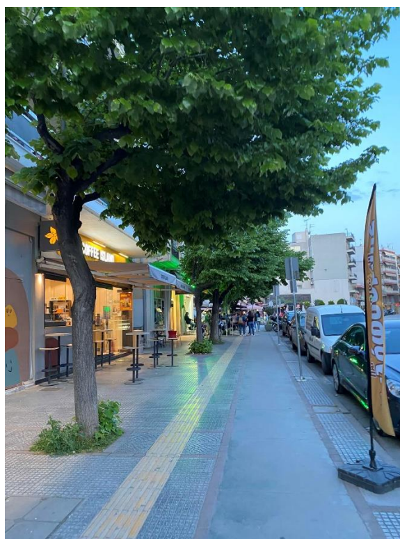
Εικόνα 40 Πεζοδρόμιο με οδηγό όδευσης τυφλών και ποδηλατόδρομος με διαχωριστικές λωρίδες
