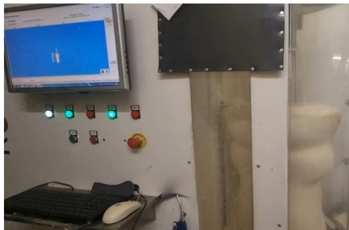
Εικόνα 4: Κατεργασία σφουγγαριού με εργαλειομηχανή.
