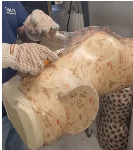
Εικόνα 7: The cutting of the plastic
