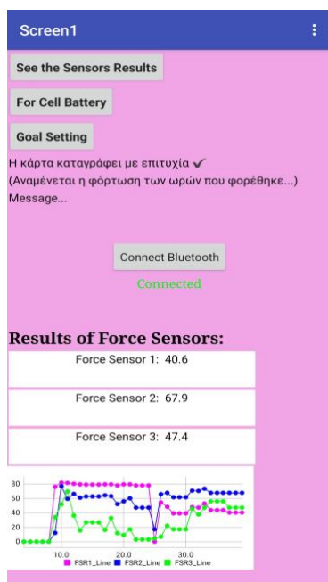
Εικόνα 40: Εικόνα Εφαρμογής αφού έχει πατηθεί το κουμπί "See the Sensors Results" και ενώ και η κάρτα SD καταγράφει και ασκούνται δυνάμεις και στους 3 αισθητήρες
