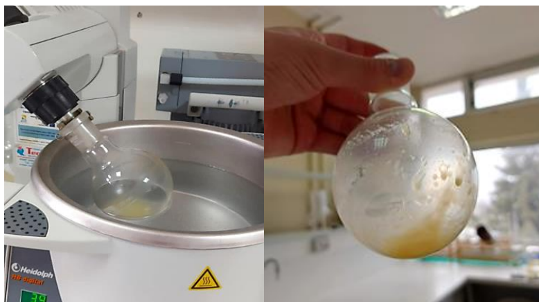
Εικόνα 6.5. Η φιάλη του Rotary μέσα στο λουτρό και το αποτέλεσμα της εξάτμισης.
