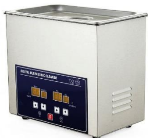
Εικόνα 5.6. Στην εικόνα αυτή απεικονίζεται ένα λουτρό υπερήχων με ρυθμιζόμενη ένταση, χρόνο και θερμοκρασία.
