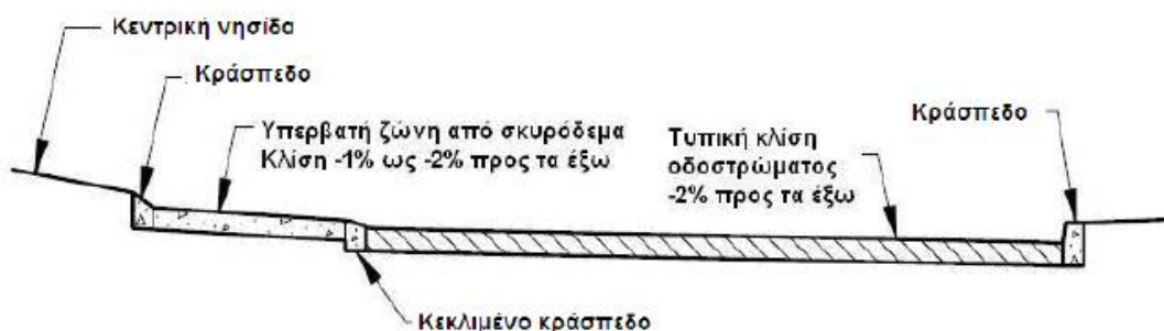
Σχήμα 32. Μονοκλινές οδόστρωμα σε δακτύλιο 1 λωρίδας. Πηγή: ΟΜΟΕ Κ 3 , 2012.
