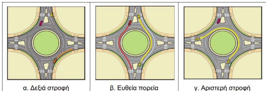
Σχήμα 2. Αναπαράσταση κινήσεων K^3 . Πηγή: ΟΜΟΕ K^3 , 2012.
