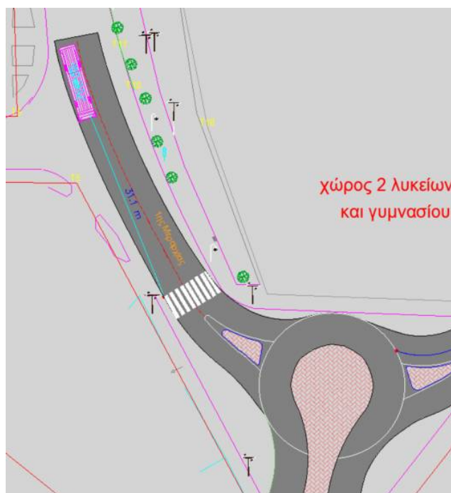
Εικόνα 15. Μήκος ορατότητας κλάδου εισόδου για στάση πριν τη διάβαση πεζών. Πηγή: Ιδία επεξεργασία
