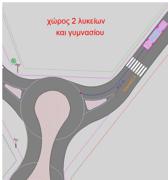
Εικόνα 18 Μήκος ορατότητας για στάση κατά την προσέγγιση στον κυκλικό κόμβο για τον ΒΑ κλάδο της οδού Καραολή Δ. Πηγή: Ιδία επεξεργασία
