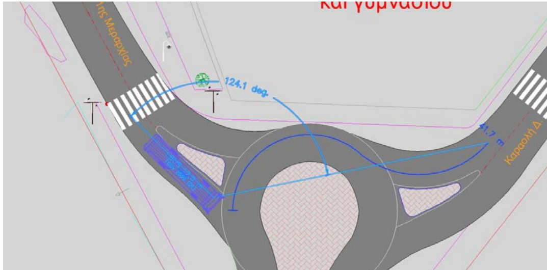
Εικόνα 21. Γωνία εισόδου στον δακτύλιο κυκλοφορίας από την ΒΔ κλάδο της οδού 1 ης Μεραρχίας. Πηγή: Ιδία επεξεργασία
