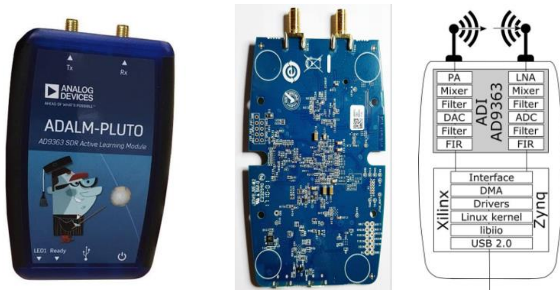
Εικόνα 8: Pluto SDR, εξωτερικά(αριστερά), εσωτερικά και σε επίπεδο components(κέντρο και δεξιά).
