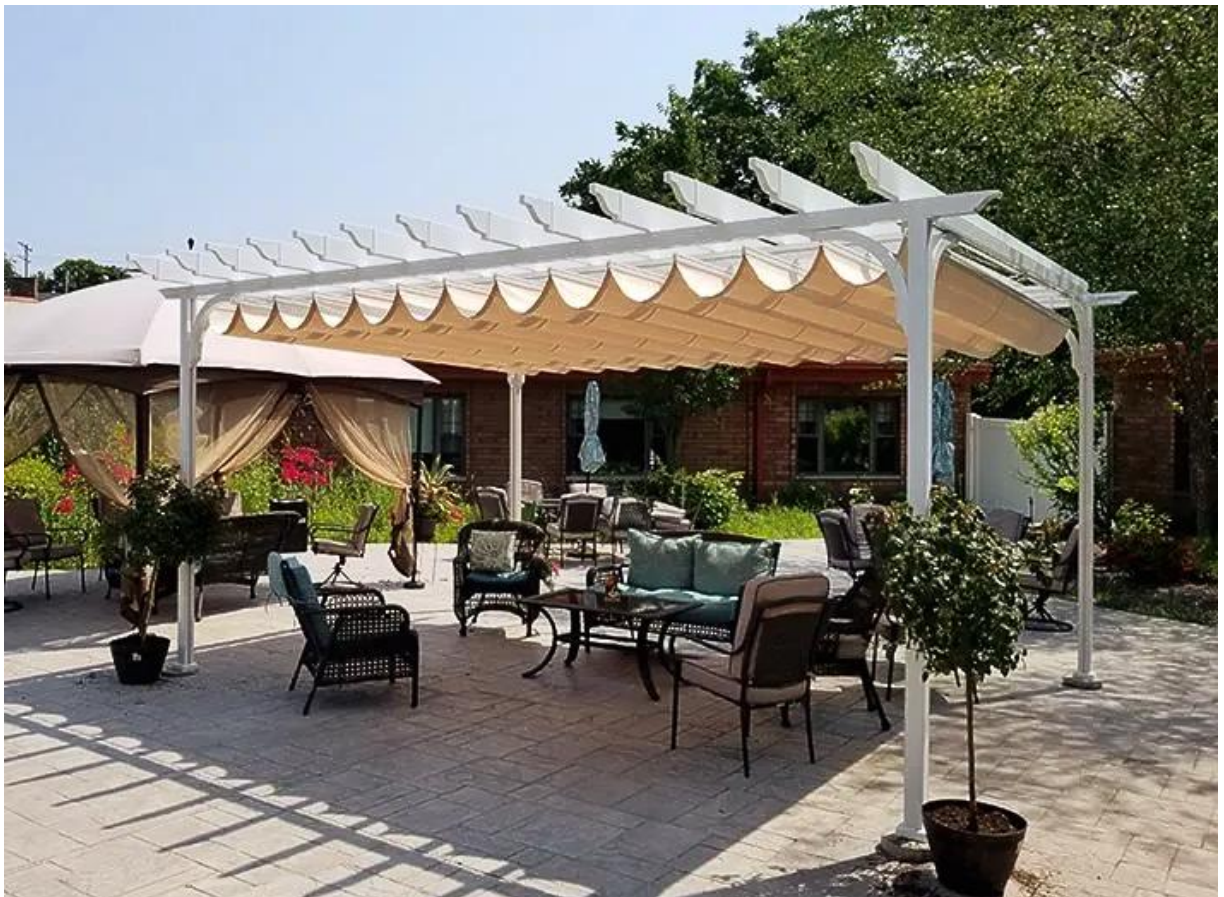
Μία τυπική πέργκολα αποτελείται από τέσσερα βασικά μέρη, τους στύλους, τις κύριες δοκούς, τις δευτερεύουσες δοκούς και το κάλυμμα
