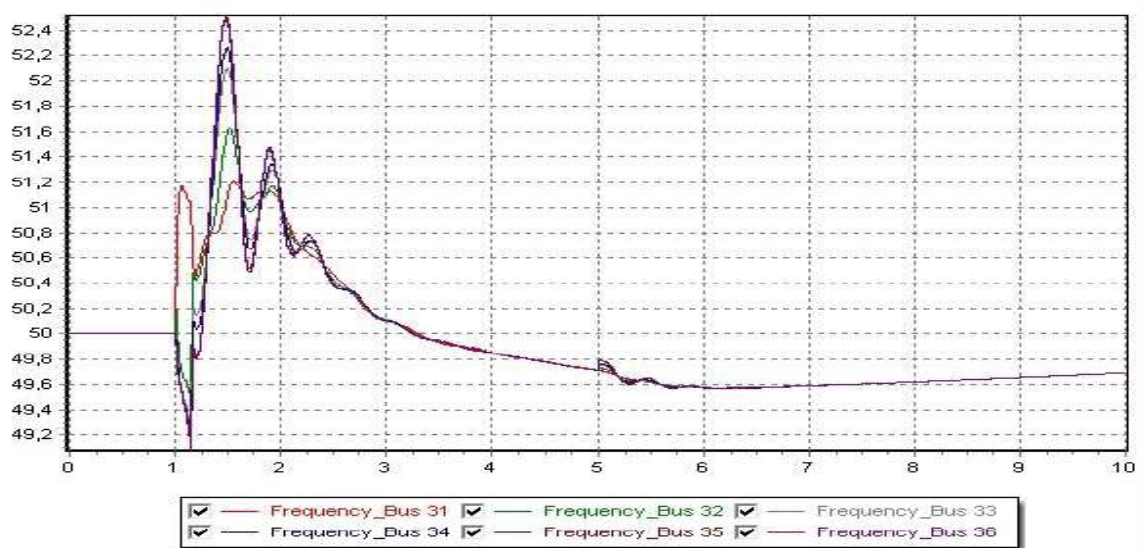
Εικόνα 7.29: Σενάριο A1T – Καμπύλες συχνοτήτων των γεννητριών και σύγχρονων αντισταθμίσεων σε συνάρτηση με το χρόνο, για χρόνο εκκαθάρισης 1,15 sec
