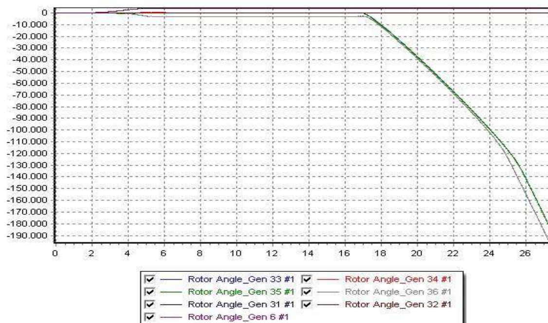
Εικόνα 7.123: Σενάριο B6M – Καμπύλες σχετικών γωνιών ισχύος ως προς τον ζυγό αναφοράς σε συνάρτηση με το χρόνο, για χρόνο εκκαθάρισης 3,95 sec (αστάθεια συστήματος)
