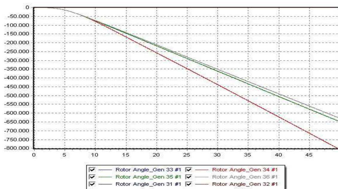
Εικόνα 7.69: Σενάριο A6T – Καμπύλες σχετικών γωνιών ισχύος ως προς τον ζυγό αναφοράς σε συνάρτηση με το χρόνο, για χρόνο εκκαθάρισης 2,15 sec (αστάθεια συστήματος)
