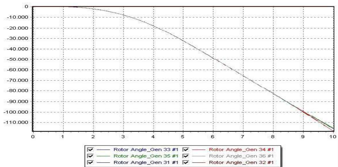
Εικόνα 7.33: Σενάριο A1T – Καμπύλες σχετικών γωνιών ισχύος ως προς τον ζυγό αναφοράς σε συνάρτηση με το χρόνο, για χρόνο εκκαθάρισης 1,2 sec (αστάθεια συστήματος)
