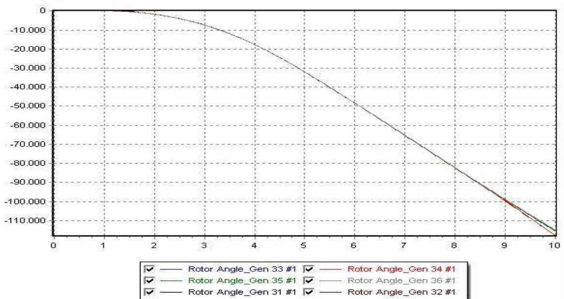
Εικόνα 7.39: Σενάριο A1M – Καμπύλες σχετικών γωνιών ισχύος ως προς τον ζυγό αναφοράς σε συνάρτηση με το χρόνο, για χρόνο εκκαθάρισης 1,25 sec (αστάθεια συστήματος)
