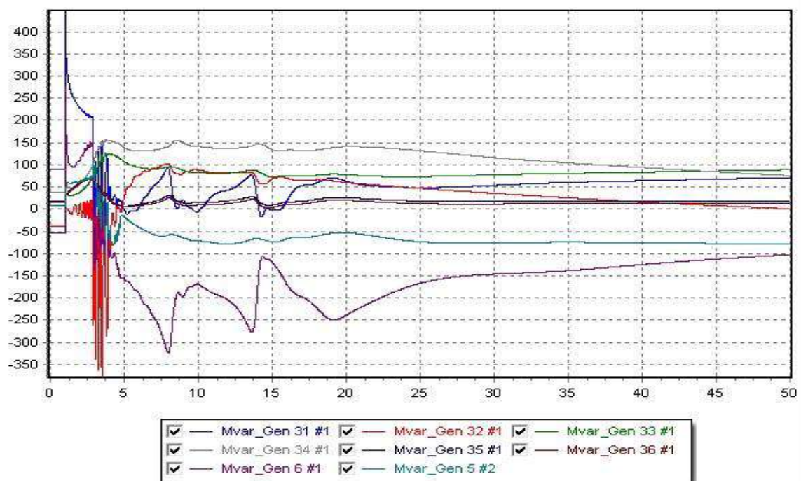
Εικόνα 7.145: Σενάριο Γ2Μ – Καμπύλες άεργου ισχύος των γεννητριών σε συνάρτηση με το χρόνο, για χρόνο εκκαθάρισης 2,9 sec
