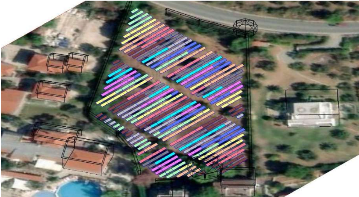
Εικόνα 3.39: Τοποθέτηση των strings
