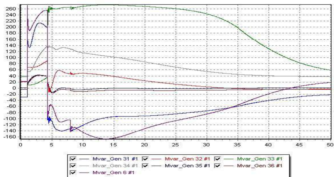
Εικόνα 7.109: Σενάριο B5M – Καμπύλες άεργου ισχύος των γεννητριών σε συνάρτηση με το χρόνο, για χρόνο εκκαθάρισης 4,25 sec
