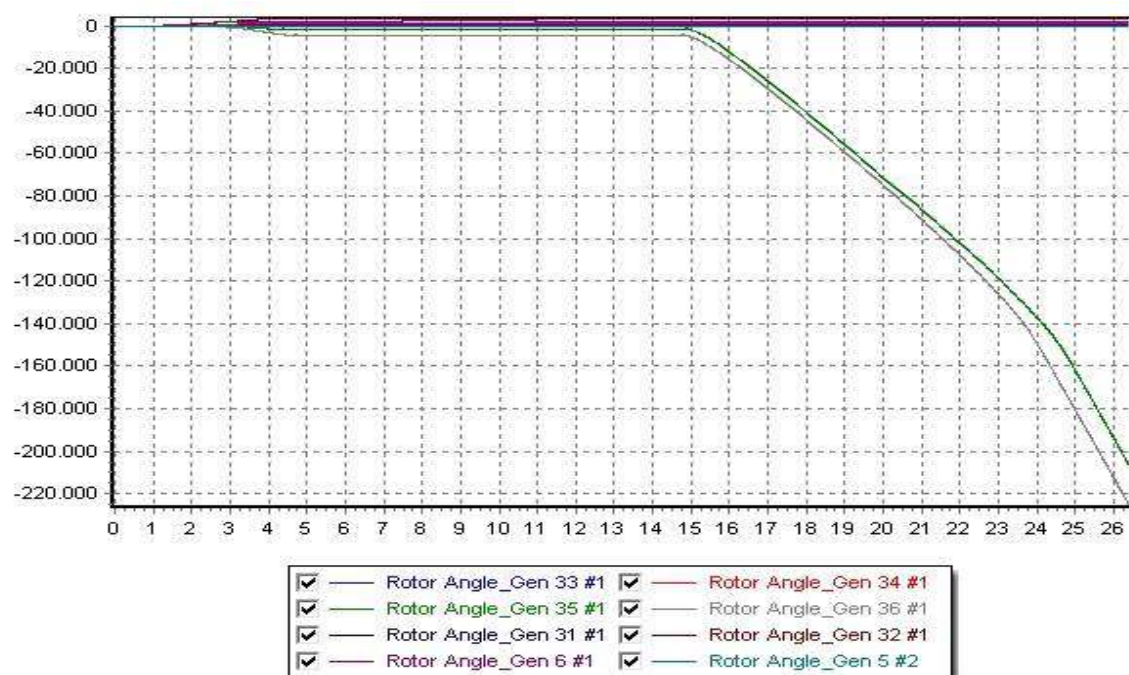
Εικόνα 7.165: Σενάριο Γ6Τ – Καμπύλες σχετικών γωνιών ισχύος ως προς τον ζυγό αναφοράς σε συνάρτηση με το χρόνο, για χρόνο εκκαθάρισης 1,8 sec (αστάθεια συστήματος)
