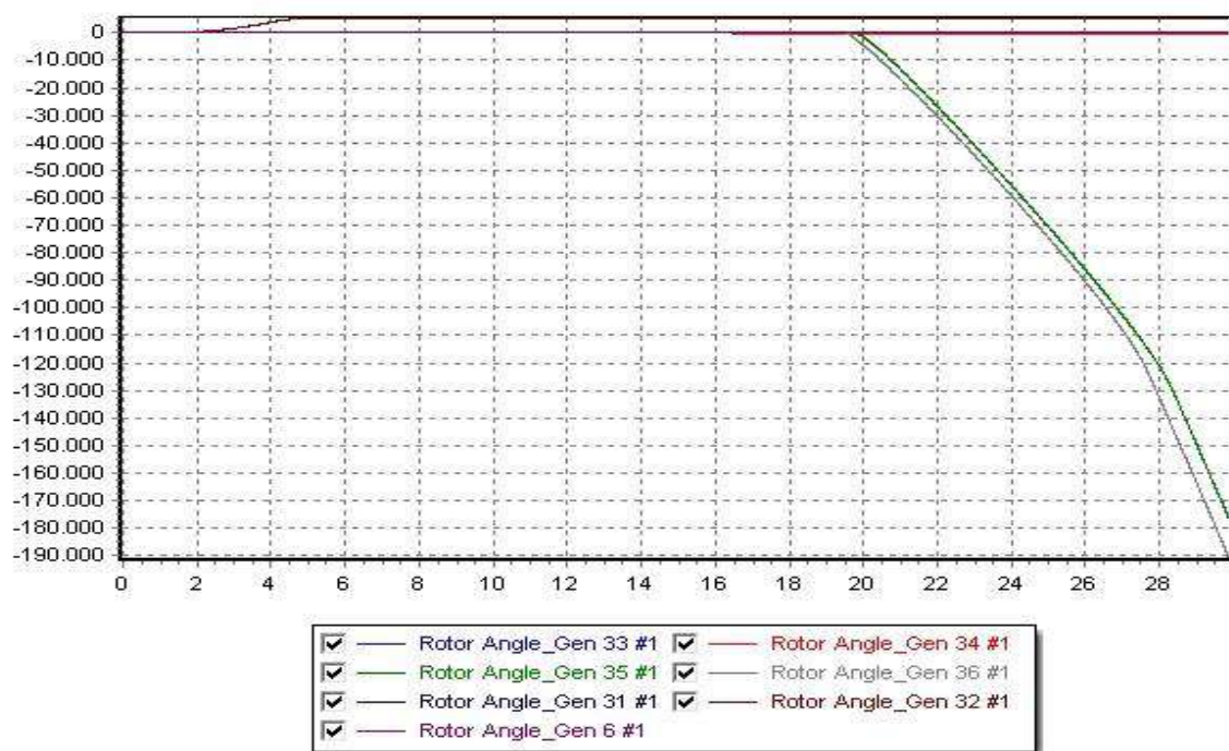
Εικόνα 7.99: Σενάριο B2M – Καμπύλες σχετικών γωνιών ισχύος ως προς τον ζυγό αναφοράς σε συνάρτηση με το χρόνο, για χρόνο εκκαθάρισης 4 sec (αστάθεια συστήματος)
