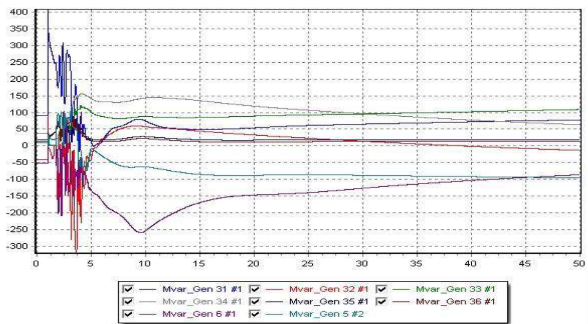
Εικόνα 7.163: Σενάριο Γ6Τ – Καμπύλες άεργου ισχύος των γεννητριών σε συνάρτηση με το χρόνο, για χρόνο εκκαθάρισης 1,75 sec
