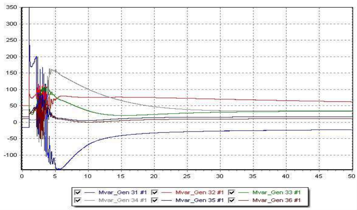
Εικόνα 7.67: Σενάριο A6T – Καμπύλες άεργου ισχύος των γεννητριών σε συνάρτηση με το χρόνο, για χρόνο εκκαθάρισης 2,1 sec
