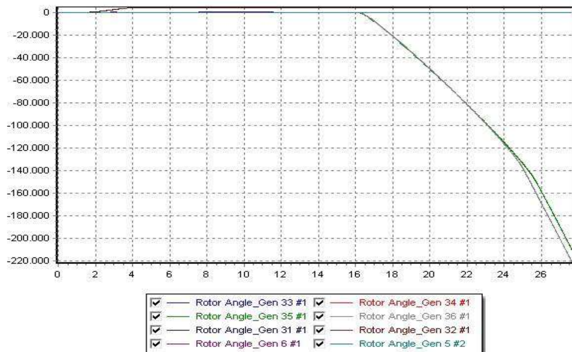
Εικόνα 7.141: Σενάριο Γ2Τ – Καμπύλες σχετικών γωνιών ισχύος ως προς τον ζυγό αναφοράς σε συνάρτηση με το χρόνο, για χρόνο εκκαθάρισης 2,9 sec (αστάθεια συστήματος)
