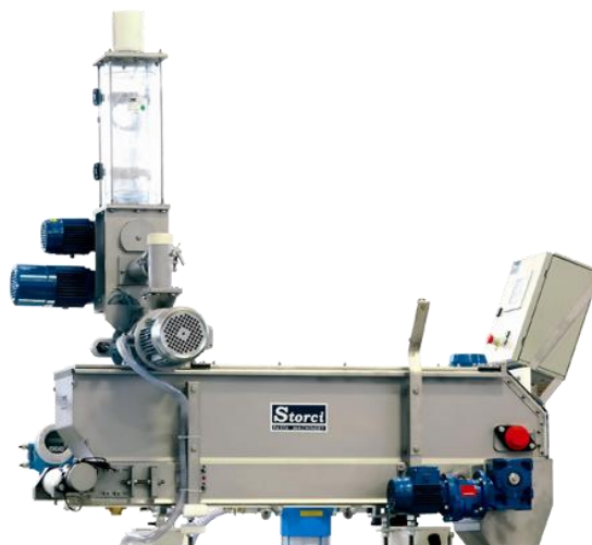
Εικόνα 8: Βιομηχανικός εξωθητήρας ζυμαρικών Storci:Ο εξοπλισμός αυτός επιτρέπει την ομοιόμορφη ανάμειξη και εξώθηση της ζύμης υπό ελεγχόμενες συνθήκες, συμβάλλοντας στη διατήρηση του χρώματος, της υφής και της ποιότητας των τελικών προϊόντων (Storci, n.d.).
