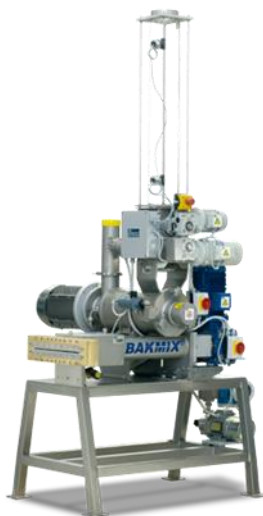
Εικόνα 7: Σύστημα Bakmix: Πετυχαίνει σωστή ενυδάτωση ανεξάρτητα από το μέγεθος των σωματιδίων μαζί με ακριβή και επαναλαμβανόμενη δοσολογία (Storci, n.d.).
