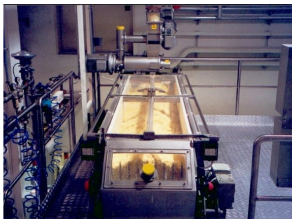
Εικόνα 9: Ιμάντας σταθεροποίησης ζύμης Beltmix: Χρησιμοποιείται στη βιομηχανία ζυμαρικών και αρτοσκευασμάτων για να σταθεροποιεί το σχήμα της ζύμης κατά τη μεταφορά, αποτρέποντας ανεπιθύμητες παραμορφώσεις, να ελέγχει το πάχος και την ομοιομορφία του ζυμαριού πριν τη μορφοποίηση ή την κοπή, να μειώνει τη δημιουργία φυσαλίδων αέρα και επιφανειακών ρωγμών μέσω ήπιας πίεσης καθώς και να διασφαλίζει σταθερή τροφοδοσία στην επόμενη φάση (π.χ. κοπή, ξήρανση) (Storci, n.d.).
