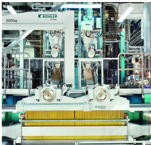
Εικόνα 5: Πρέσα Polymatic: Ο σύντομος χρόνος ανάμειξης (~20 δευτ.) περιορίζει την οξείδωση των κιτρίνων χρωστικών, δίνοντας ζυμαρικά με έντονο χρυσαφένιο χρώμα και άριστα μαγειρικά χαρακτηριστικά (Dexter, 2004).
