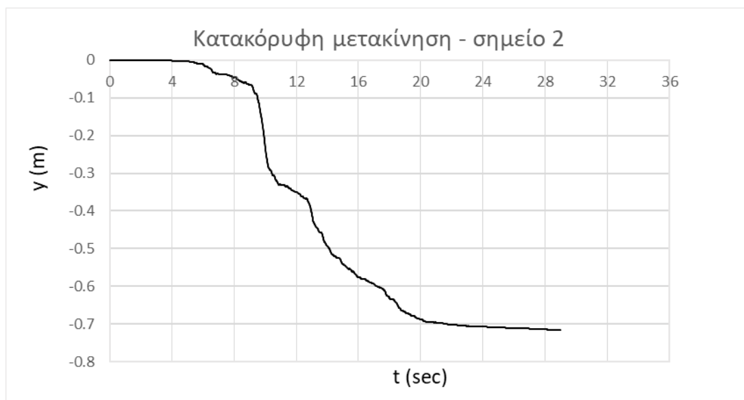
Εικόνα 3.15. Διάγραμμα εξέλιξης κατακόρυφης μετακίνησης πρανούς στη βάση του 1ου αναβαθμού
