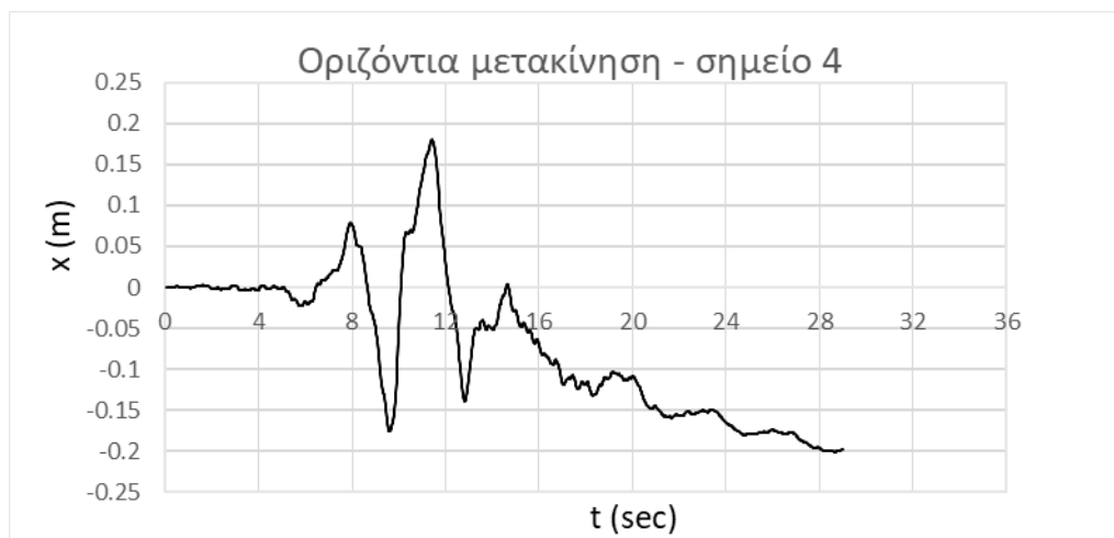
Εικόνα 3.16. Διάγραμμα εξέλιξης οριζόντιας μετακίνησης πρανούς στη βάση του 2ου αναβαθμού
