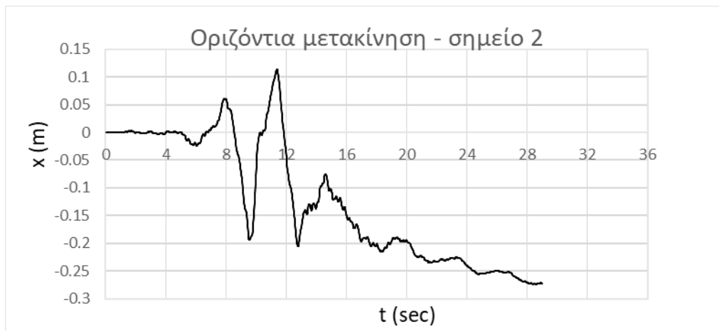
Εικόνα 3.15. Διάγραμμα εξέλιξης οριζόντιας μετακίνησης πρανούς στη βάση του 1ου αναβαθμού
