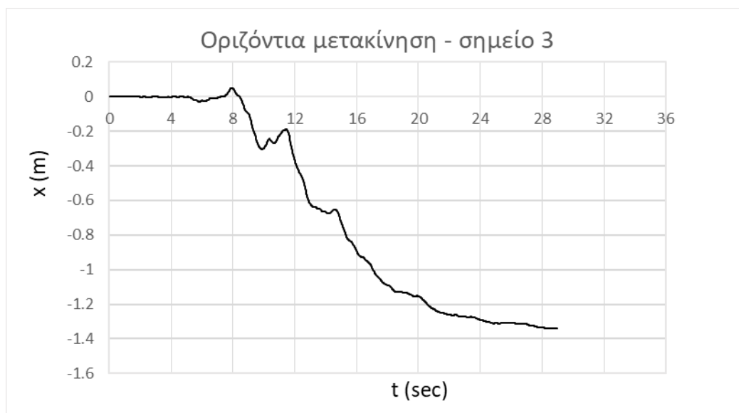
Εικόνα 3.16. Διάγραμμα εξέλιξης οριζόντιας μετακίνησης πρανούς στη βάση του 2ου αναβαθμού
