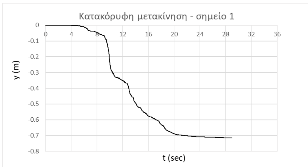
Εικόνα 3.14. Διάγραμμα εξέλιξης κατακόρυφης μετακίνησης πρανούς στην κορυφή του 1ου αναβαθμού
