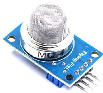
Εικόνα 3 - Αισθητήριο στοιχείο MQ-4
