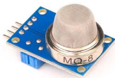
Εικόνα 5 - Αισθητήριο στοιχείο MQ-8
