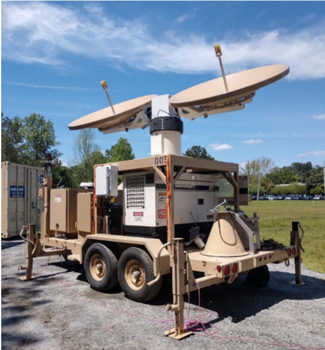
Εικόνα 6: Κινητό σύστημα jamming (EW) με διπλές κατευθυντικές κεραίες σε ρυμουλκούμενη πλατφόρμα.
