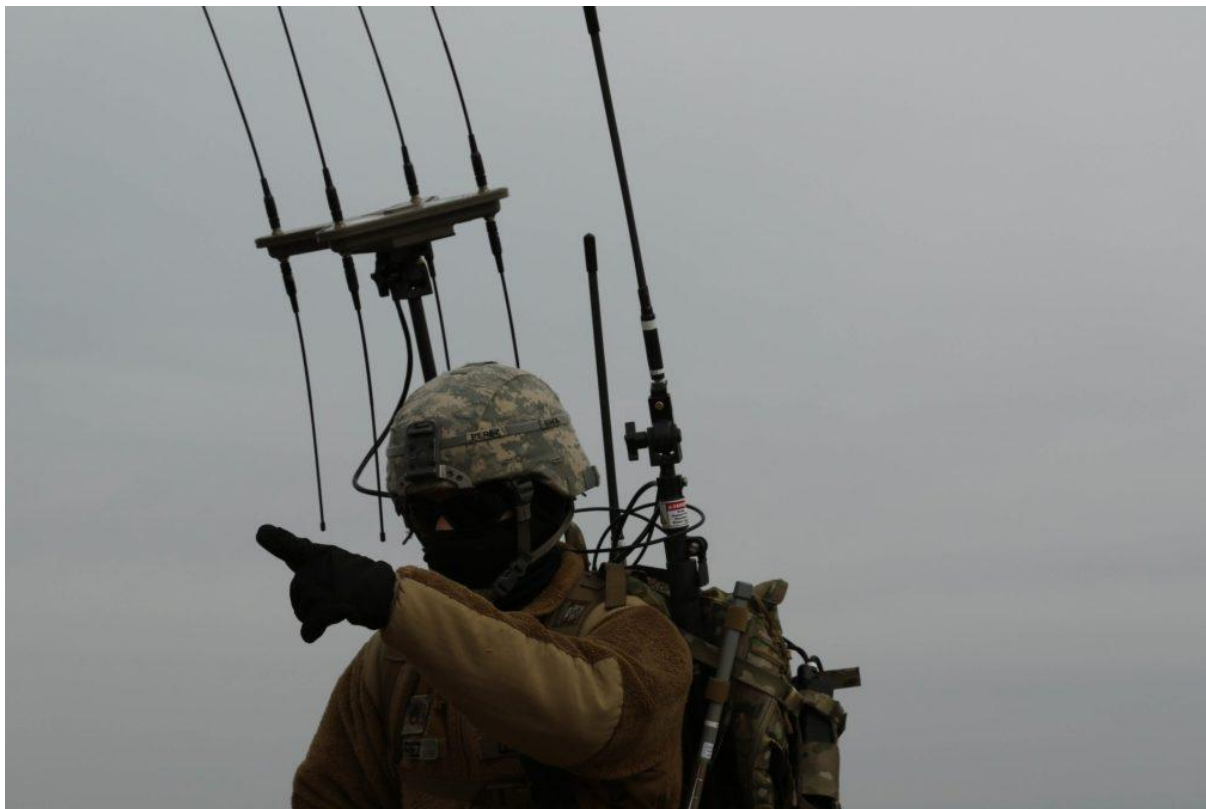
Εικόνα 7: Φορητό σύστημα RF jamming για προστασία από IED/DRONE απειλές (πηγή: https://defensescoop.com/2023/09/15/army-awards-contract-for-dismounted-electronic-jammer/ )
