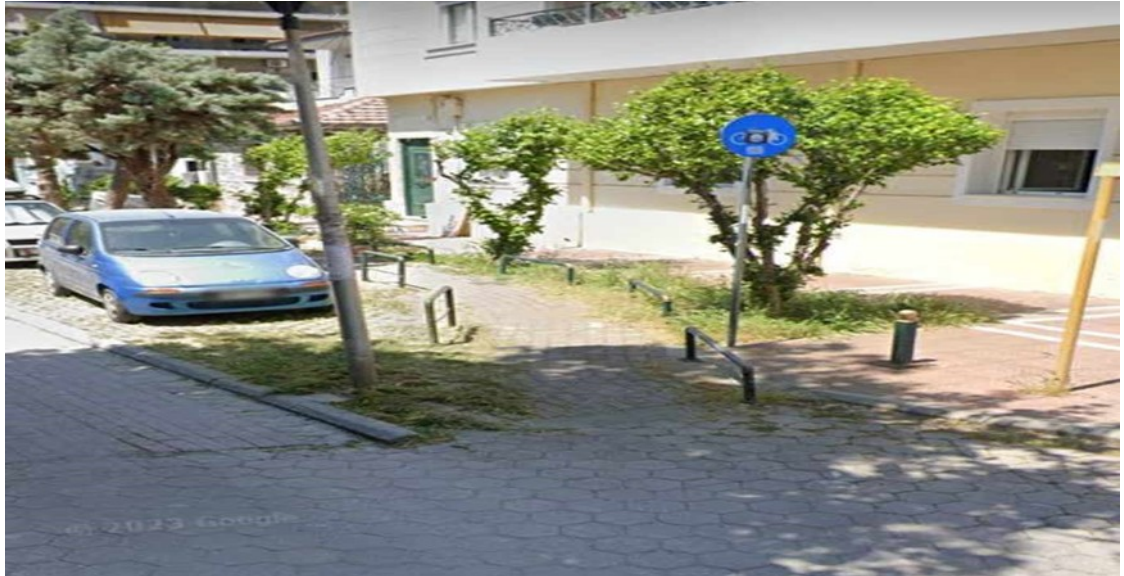
Εικόνα Error: Reference source not found.23: Ο Ποδηλατόδρομος στην Οδό Ρήγα Φεραίου σε Πεζόδρομο (Παρατηρείται η απότομη στένωση και στροφή, χρειάζεται υποχρεωτικός ελιγμός του ποδηλάτη), Πηγή: Podhlates.gr
