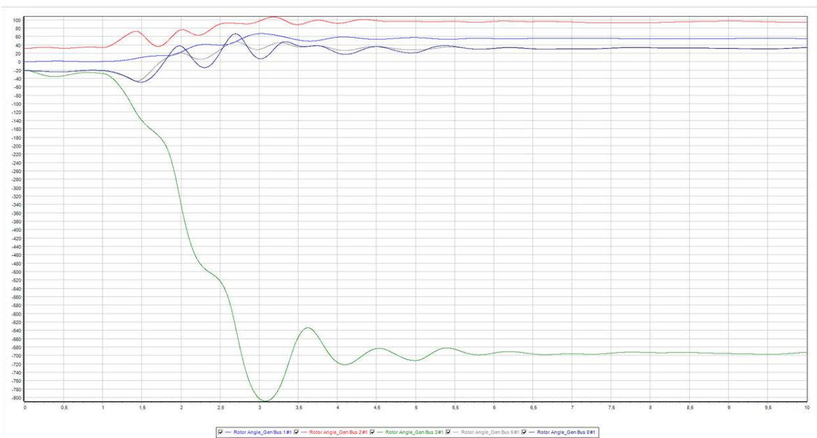
Σχήμα 5.20 Καμπύλη σχετικής γωνίας γεννητριών για 3LG στη γραμμή 4-5 με απώλεια της γραμμής 2-3 για χρόνο εκκαθάρισης σφάλματος 0,38 sec.
