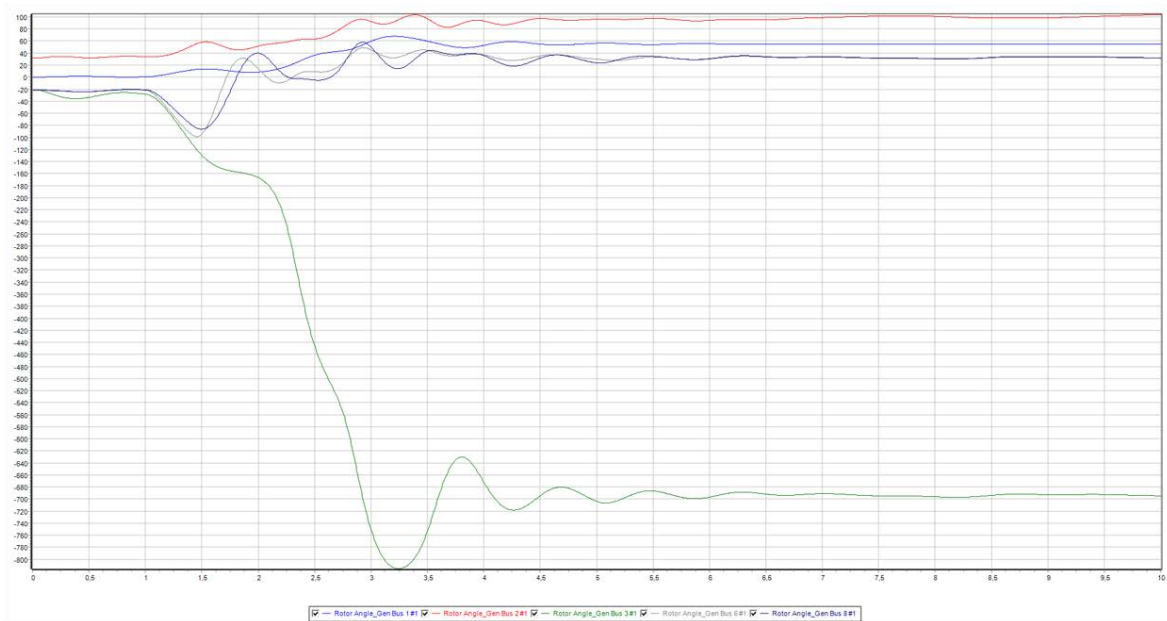
Σχήμα 5.26 Καμπύλη σχετικής γωνίας γεννητριών για SLG στη γραμμή 4-5 με απώλεια της γραμμής 2-3 για χρόνο εκκαθάρισης σφάλματος 0,42 sec.
