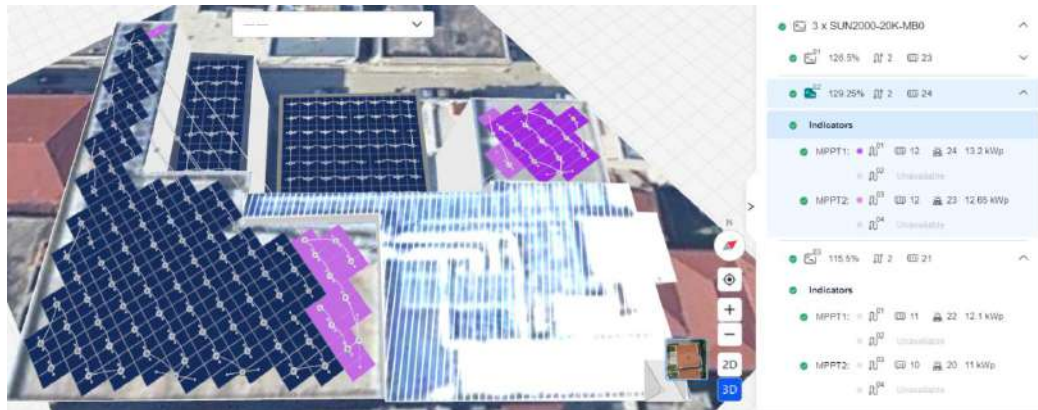
Εικόνα 9.6: Μονάδες που καλύπτει ο αντιστροφέας SUN2000-20K-MB0 (2)
