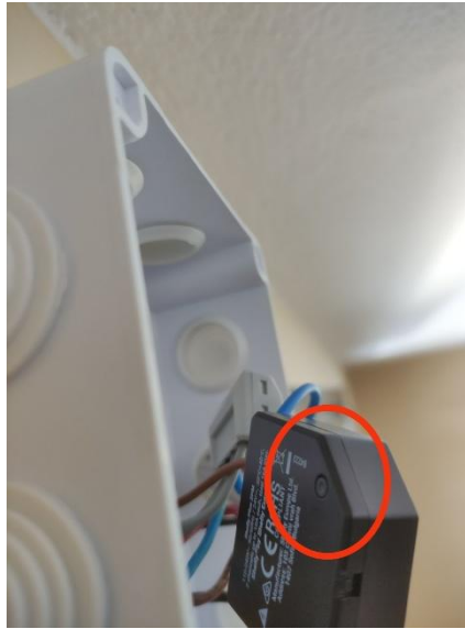
Εικόνα 13: Το κουμπί reset στο πίσω μέρος ενός Shelly plus 2PM.
