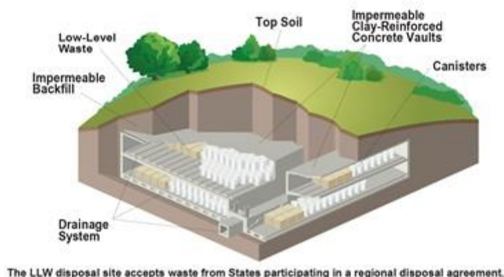
Εικόνα 15- Σχεδιάγραμμα των δομών και επιπέδων μιας βάσης ταφής πυρηνικών αποβλήτων (American Nuclear Society, 2022)
