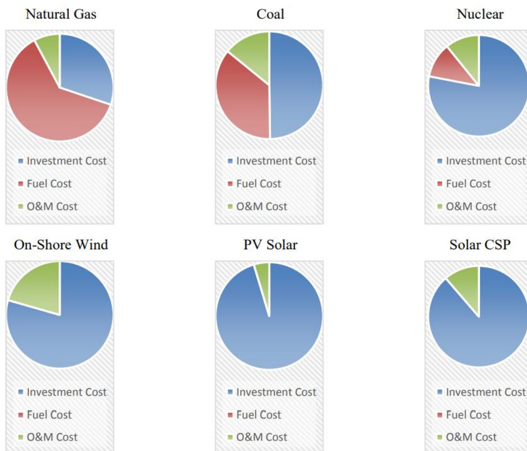
Εικόνα 25 – Σύγκριση των ποσοστών κόστους εργοστασίων παραγωγής ενέργειας από διάφορες μορφές. Όπως φαίνεται στα διαγράμματα, σε αντίθεση με τις περιπτώσεις του φυσικού αερίου ( natural gas ) και του άνθρακα ( coal ), η πυρηνική ενέργεια παρουσιάζει πολύ μικρότερα κόστη καυσίμου (Dawson, 2017)
