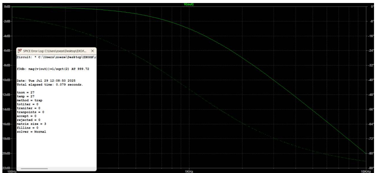
Εικόνα 2. Έξοδος βαθυπερατού παθητικού φίλτρου 1 ης τάξης συναρτήσεως της συχνότητας.
