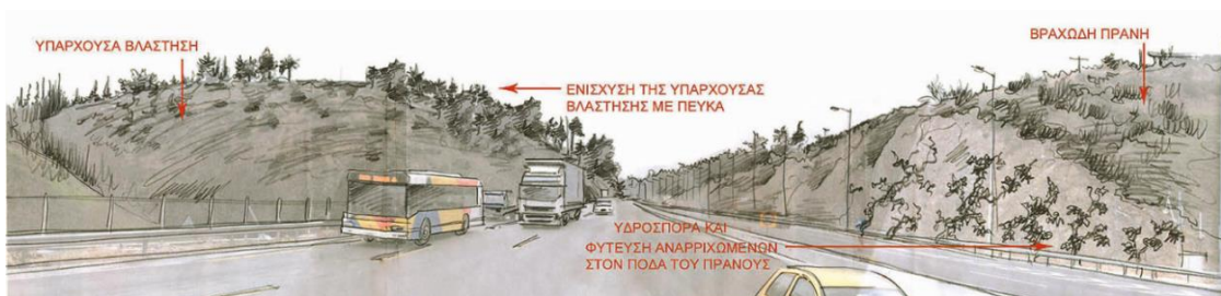
Εικόνα 2.7: Αποκατάσταση του τοπίου στην παράκαμψη Καβάλας της Εγνατίας Οδού
