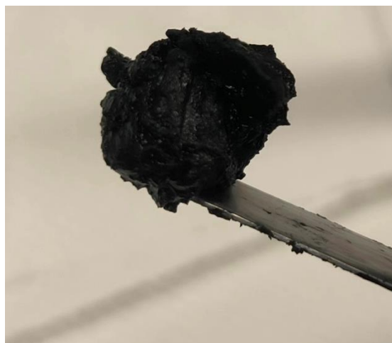
Εικόνα 5.14. καταλυτικό μελάνι αποτελούμενο από 92wt% H_2O / 8wt% CMC / 20wt% rGO/ 2vol% 1-octanol μεθόδου παρασκευής B.
