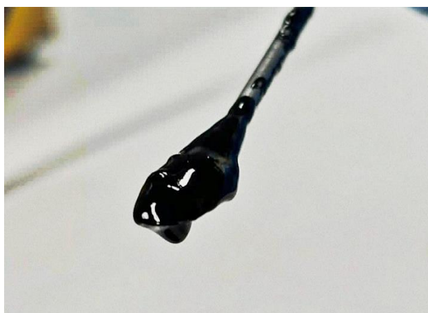
Εικόνα 5.5. Καταλυτικό μελάνι αποτελούμενο από 92wt% H 2 O / 8wt% CMC / 5wt% rGO/ 2vol% 1-octanol μεθόδου παρασκευής B
