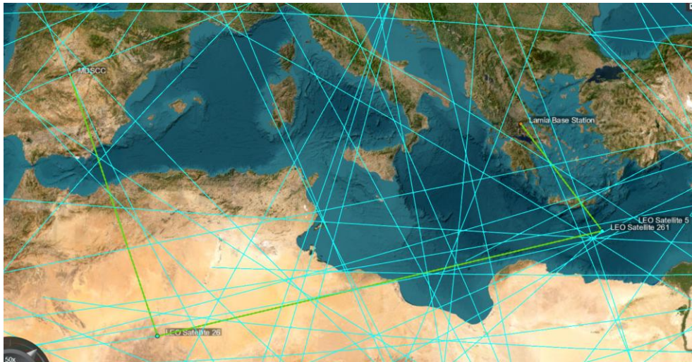
Σχήμα 49: Απεικόνιση ζεύξης με δύο αναπηδήσεις.
