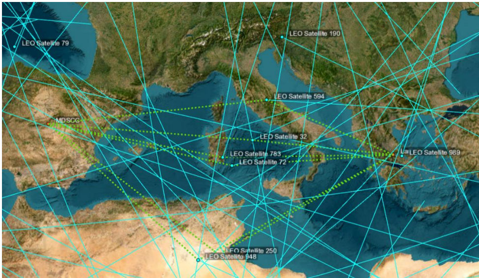
Σχήμα 47: Απεικόνιση δορυφόρων σε οπτική επαφή και από τους δύο σταθμούς. Εγκατάσταση δικτύου 1 hor.
