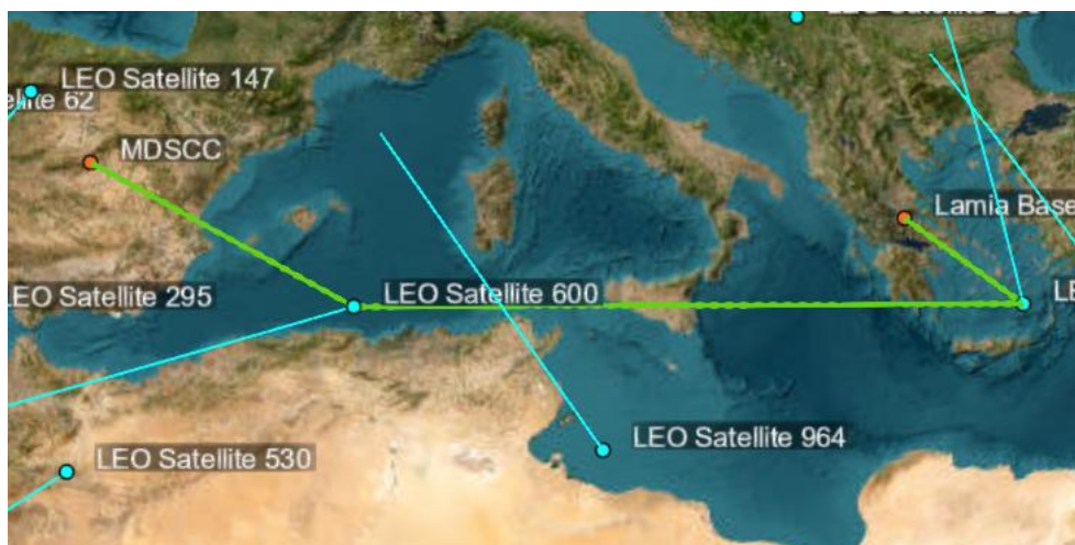
Σχήμα 48: Απεικόνιση ζεύξης κατά την επιλογή του δορυφόρου-αναμεταδότη.
