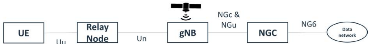
Σχήμα 14: Μη-επίγειο δίκτυο με αναμεταδότη και ενσωματωμένο gNB στον μη-επίγειο κόμβο [2].
