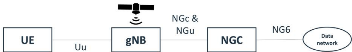
Σχήμα 12: Μη-Επίγειο Δίκτυο με gNB ενσωματωμένο στον μη-επίγειο κόμβο [2].
