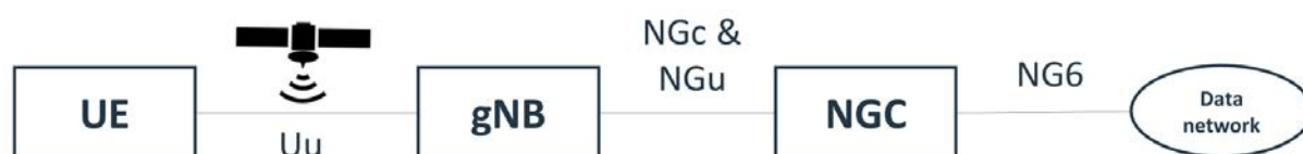
Σχήμα 11: Μη-Επίγειο Δίκτυο με χρήση μη-επίγειου κόμβου ως αναμεταδότη [2].
