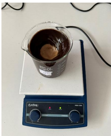
Εικόνα 11 Συνεχής ανάδευση του δείγματος πάνω σε θερμαινόμενη πλάκα
