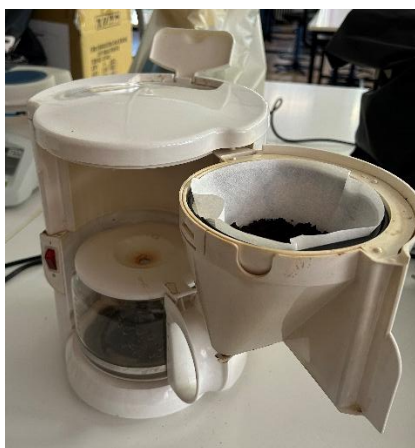
Εικόνα 12 Συσκευή Εκχύλισης Τροποποιημένης Soxhlet Solid Liquid Extraction - Τροποποιημένη Soxhlet
