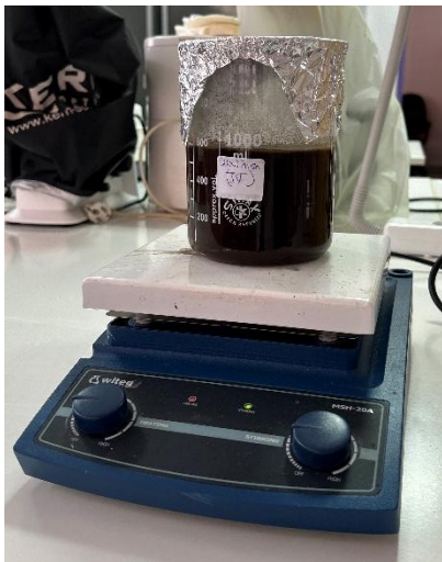
Εικόνα 14 Solid Liquid Extraction 24ώρες βρασμός με συνεχή ανάδευση
