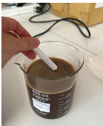
Εικόνα 10 Τοποθέτηση Μαγνήτη Ανάδευσης στο δείγμα για συνεχή ανάδυσή του
