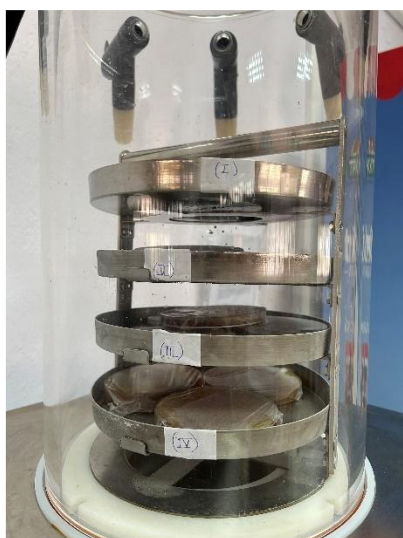
Εικόνα 25 Δεύτερο στάδιο της διαδικασίας λυοφιλοποίησης. Σε κάθε ταψάκι βρίσκονται και τα δείγματα από κάθε εκχύλιση.
