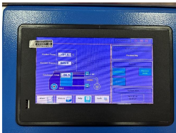
Εικόνα 26 Θερμοκρασίες στους θαλάμους της συσκευής Λυοφιλοποίησης σε μια χρονική στιγμή του πειράματος
