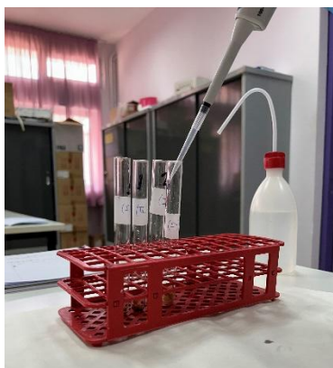
Εικόνα 27 Παρασκευή δειγμάτων με την μέθοδο Folin-Ciocalteu
