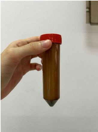
Εικόνα 18 Δείγμα μετά το πέρας της Φυγοκέντρωσης. Στο κάτω μέρος του Falcon διακρίνεται ίζημα
