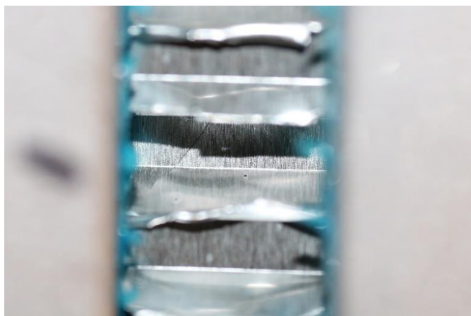
ΕΙΚΟΝΑ 4.1.4. 1 Διάδοση ρωγμής
