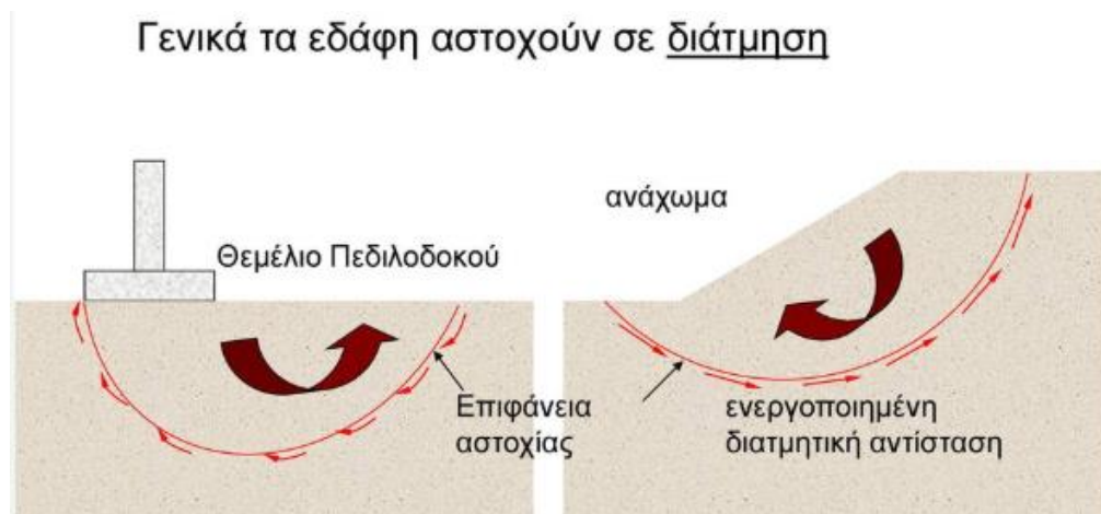
Εικόνα 12: Διατμητική Αστοχία. Κατά την αστοχία, η διατμητική τάση κατά μήκος της επιφάνειας αστοχίας φθάνει στη διατμητική αντοχή του εδάφους.
