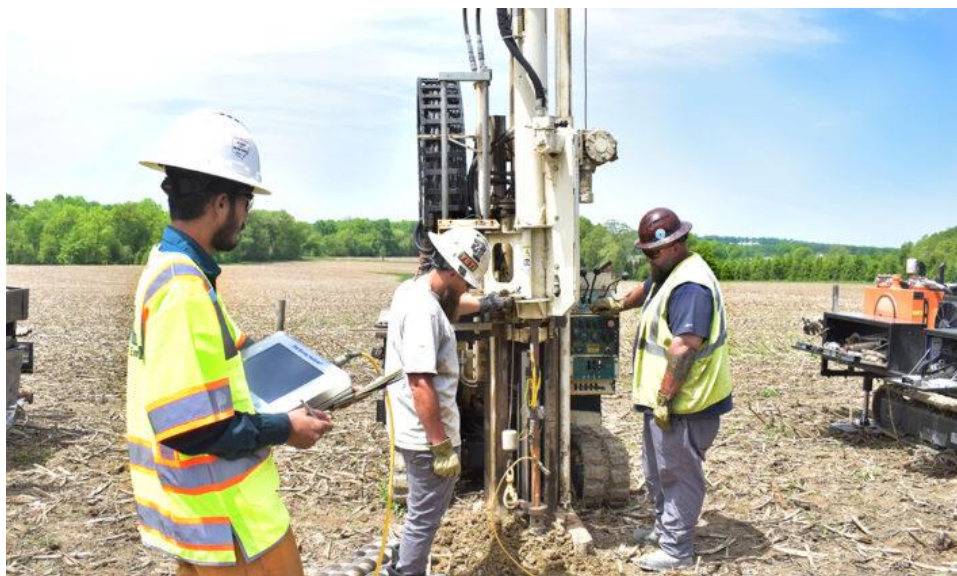
Εικόνα 14: Χρήση μεθόδου SPT.
