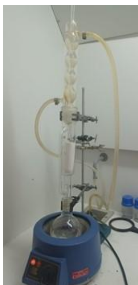
Εικόνα 2.3. Εκχύλιση κατά Soxhlet
