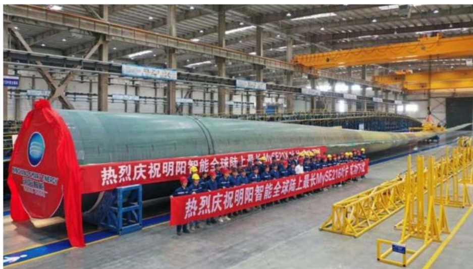
Εικόνα 2.3: Η εταιρεία MingYang (Κίνα) κατασκεύασε πτερύγιο επίγειας Α/Γ με μήκος 107 m από υαλοβάμβακα που μειώνει το βάρος και αναβαθμίζει την αντοχή της [9]
