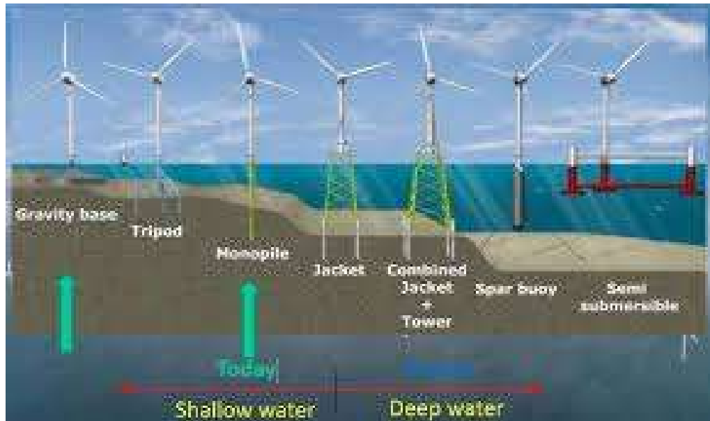
Εικόνα 3.6: Τυπικές διατάξεις έδρασης υπεράκτιων Α/Γ σε σχέση με το βάθος
