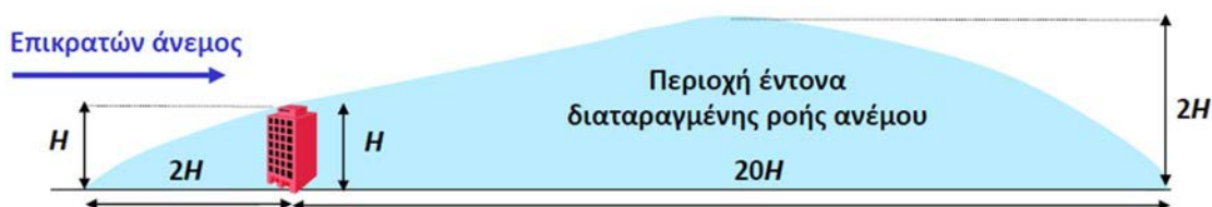
Σχήμα 2.6: Επίδραση εμποδίου ύψους 20 m και μήκους 60 m σε Α/Γ ύψους 50 m τοποθετημένης σε απόσταση 300 m
