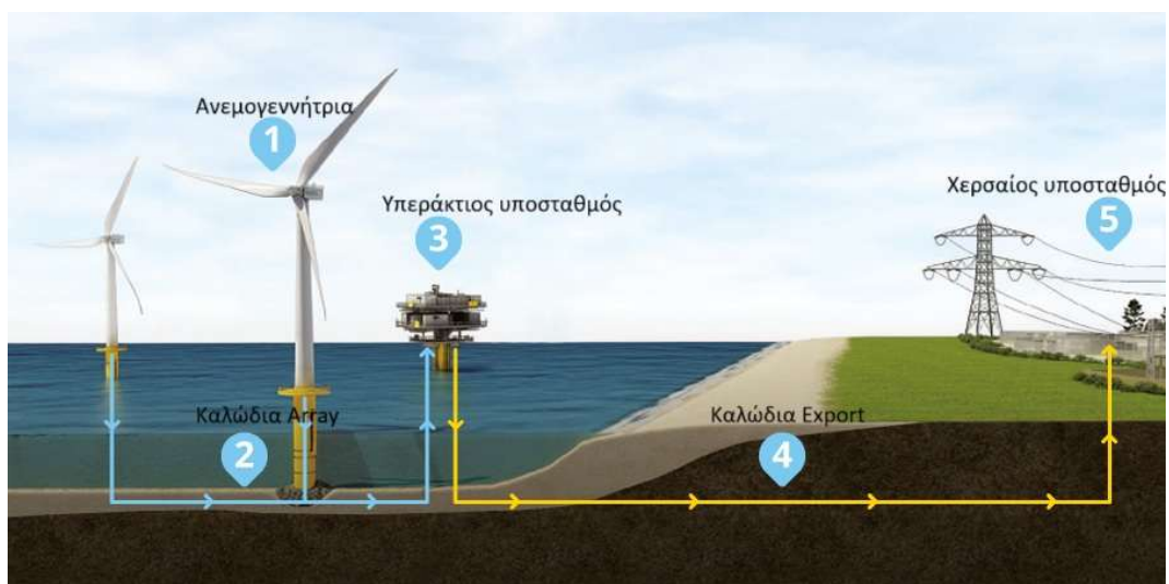
Εικόνα 5.2: Σκαρίφημα βασικής διάταξης του London Array [31]
