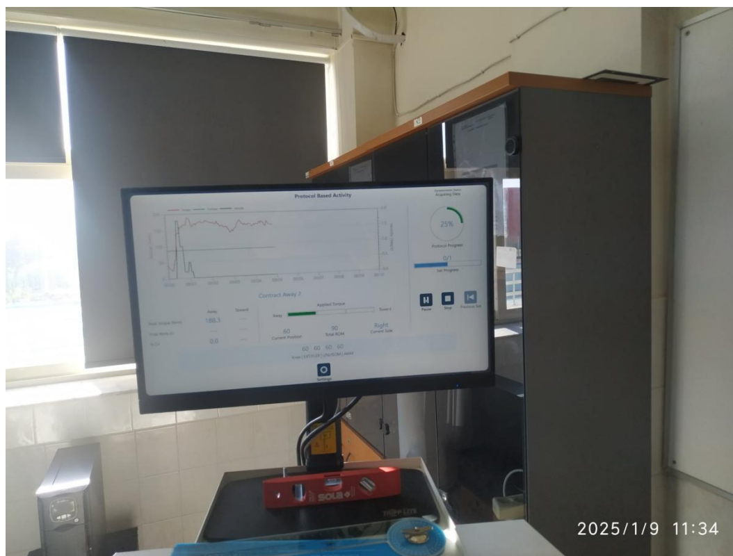
Εικόνα 3.4- Αναπαράσταση της μυϊκής ροπής όπως καταγράφηκε από το ισοκινητικό δυναμόμετρο Biodex System 3
