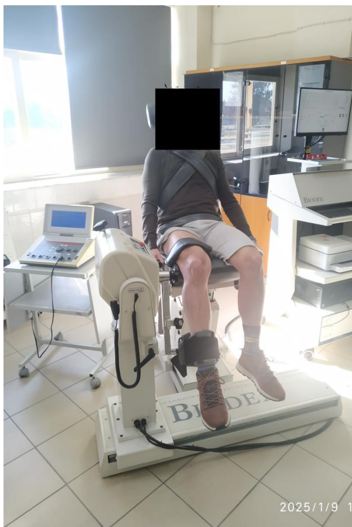
Εικόνα 3.1 - Ισομετρική Δυναμομέτρηση χωρίς ηλεκτρική διέγερση
