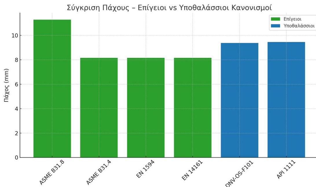
Σχεδιάγραμμα 16: Οι Υποθαλάσσιες Εφαρμογές (DNV-OS-F101, API 1111) Απαιτούν Συνήθως Μεγαλύτερα Πάχη Λόγω Αυξημένων Εξωτερικών Φορτίσεων
