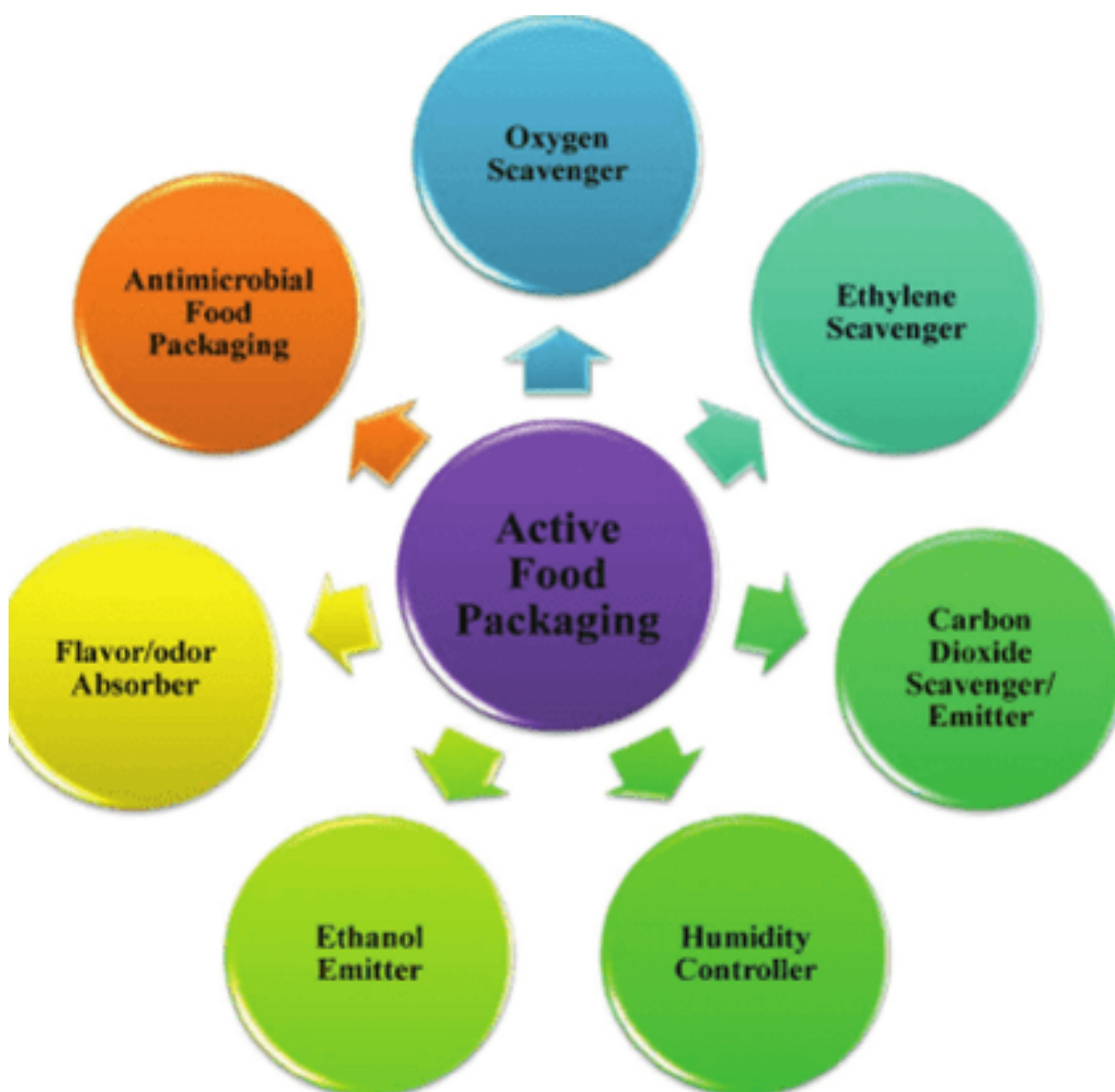
Εικόνα 3. Βασικές κατηγορίες ενεργής συσκευασίας τροφίμων, όπως απορροφητές οξυγόνου, αιθυλενίου, υγρασίας, εκπομποί διοξειδίου του άνθρακα και αιθανόλης, απορροφητές οσμών/γεύσεων και αντιμικροβιακή συσκευασία (Drago et al., 2020)
