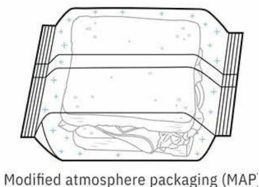
Εικόνα 16. Διάταξη συσκευασίας με τροποποιημένη ατμόσφαιρα (MAP), η οποία χρησιμοποιεί ενεργό στοιχεία όπως απορροφητές οξυγόνου ή ρυθμιστές CO 2 για να διατηρήσει τη φρεσκάδα και να επιμηκύνει τη διάρκεια ζωής του προϊόντος (Record Packaging, n.d.).
