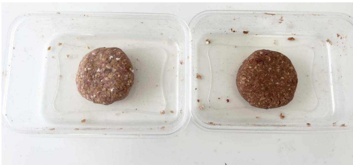
Εικόνα 49: B5 και B6 με σκόνη καλλιέργειας μανιταριών, κωνικές Α και Β
