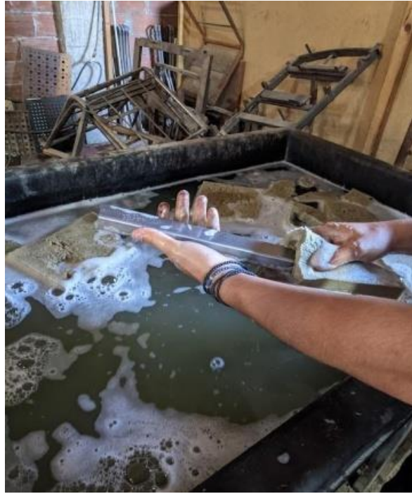
Εικόνα 54: Πλύσιμο των μεταλλικών κομματιών.
