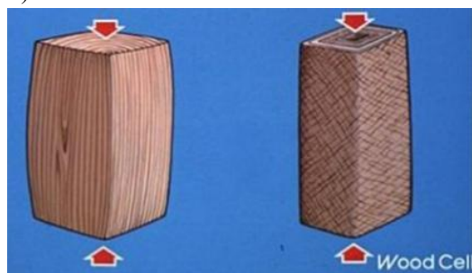
Εικόνα 21: Αντοχή του ξύλου σε θλίψη α) παράλληλα στις ίνες, β) κάθετα στις ίνες
