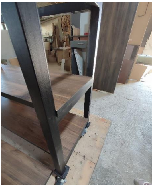
Εικόνα 65: Τοποθέτηση επιφανειών και βίδωμα.
