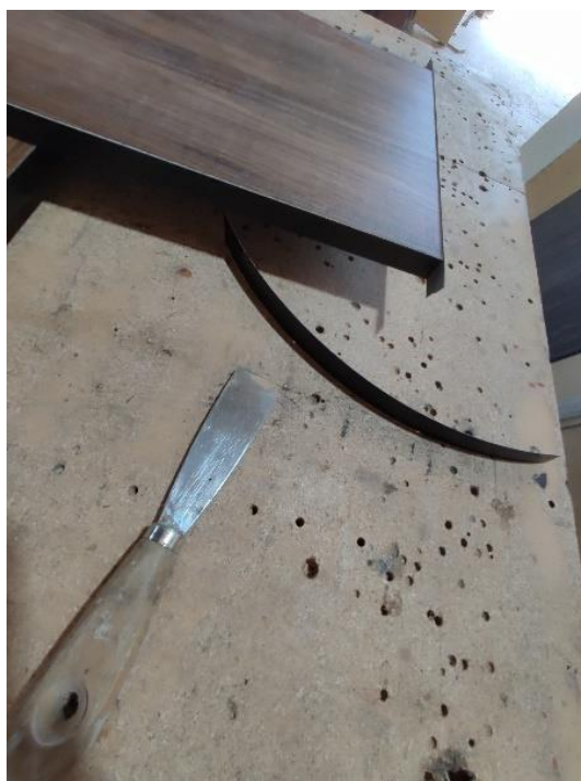
Εικόνα 52: Διαμόρφωση ταινίας με ειδική σπάτουλα.
