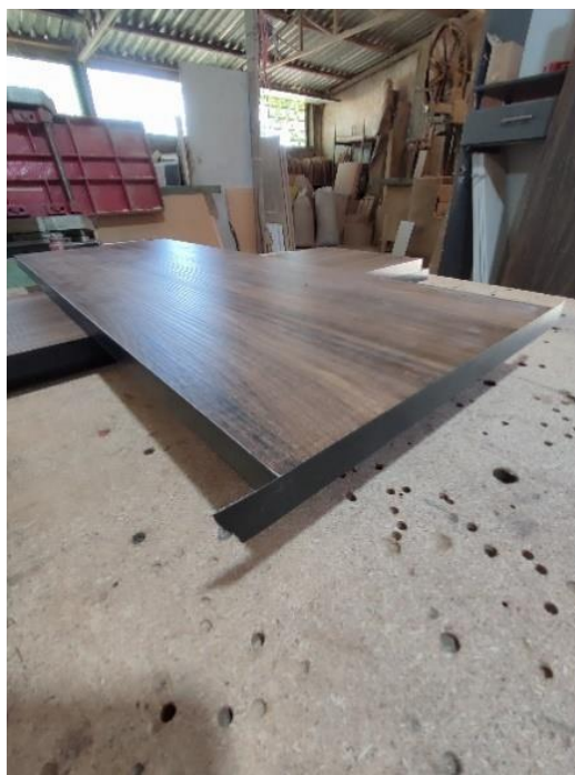
Εικόνα 51: Συγκόλληση ταινίας περιθωρίου
