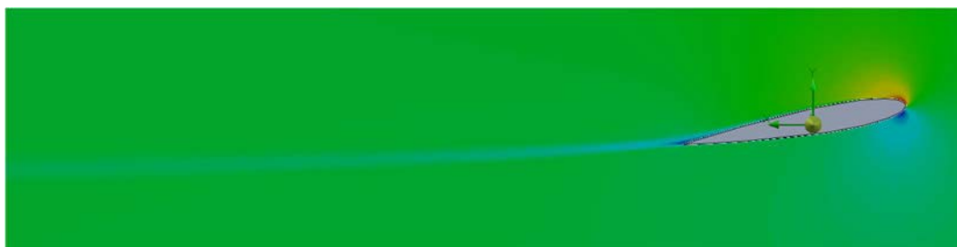
Εικόνα 17: Απόρευμα πτέρυγας Naca 0012 σε γωνία προσβολής 10 μοιρών, υπολογισμένη με το πλέγμα B
