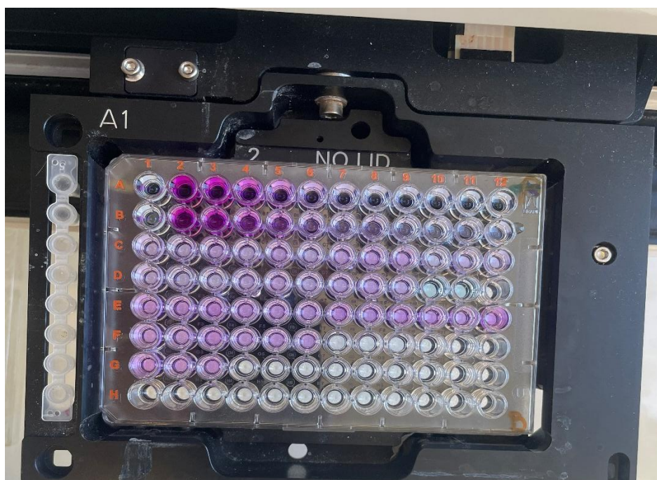
Εικόνα 7. Φωτομέτρηση της μικροπλάκας των 96 θέσεων για τον προσδιορισμό της συγκέντρωσης των γεωργικών φαρμάκων στο έδαφος.
