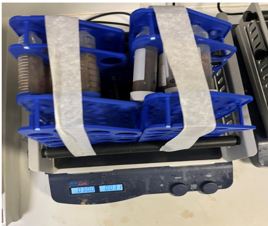
Εικόνα 6. Ανάδευση του εδάφους με 10mL KCl (1M) με σκοπό την εκχύλιση των νιτρικών.
