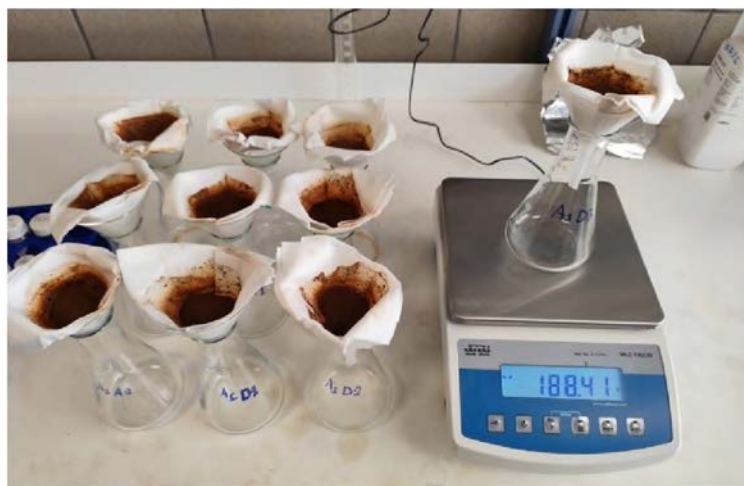
Εικόνα 11. Στιγμιότυπο από τη ζύγιση των συστημάτων (κωνική φιάλη + χωνί + ηθμός + έδαφος) για τον προσδιορισμό της υδατοχωρητικότητας.
