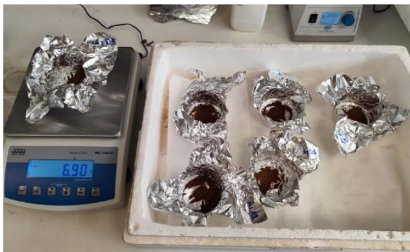
Εικόνα 10. Στιγμιότυπο από τη ζύγιση των εδαφικών δειγμάτων για τον προσδιορισμό της σχετικής υγρασίας.
