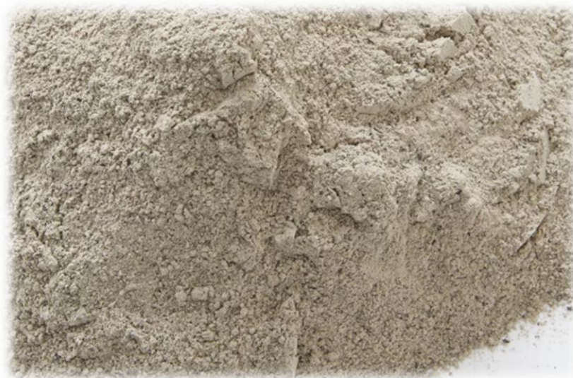
Εικόνα 2: Ιπτάμενη τέφρα - παραπροϊόν της καύσης λιγνίτη με ποζολανικές ιδιότητες.
